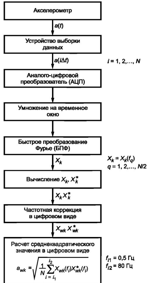
Рисунок 4 — Цифровой метод расчета среднеквадратического значения скорректированного ускорения
