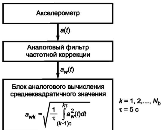
Рисунок 2 — Аналоговый метод расчета среднеквадратичного значения скорректированного ускорения
