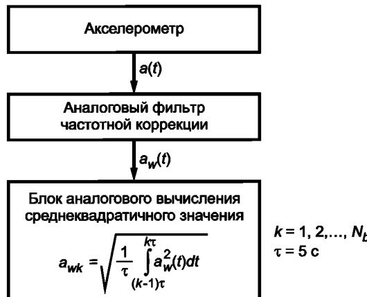
Рисунок 2 — Аналоговый метод расчета среднеквадратичного значения корректированного ускорения
