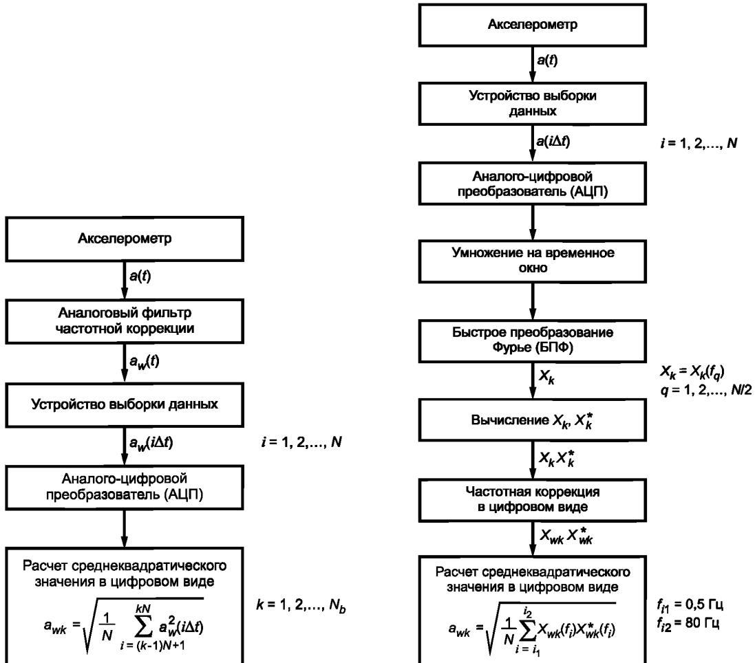
Рисунок 3 — Гибридный (аналого-цифровой) метод расчета среднеквадратичного значения корректированного ускорения
