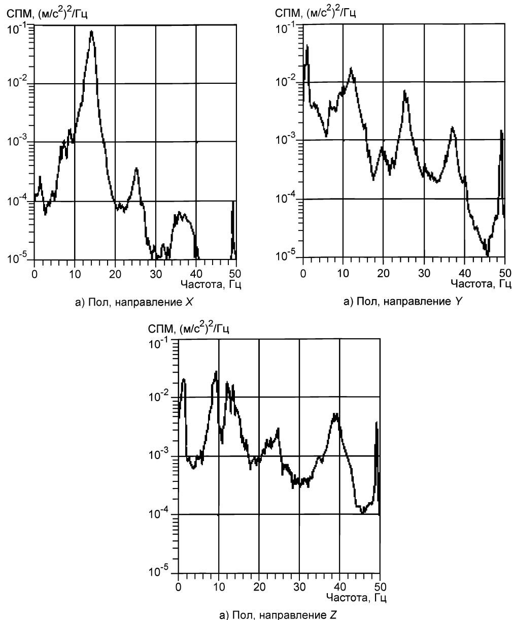
Рисунок А.3 — Спектральные плотности мощности (СПМ) корректированного сигнала ускорения на уровне пола, полученные по результатам измерений в зоне 1
