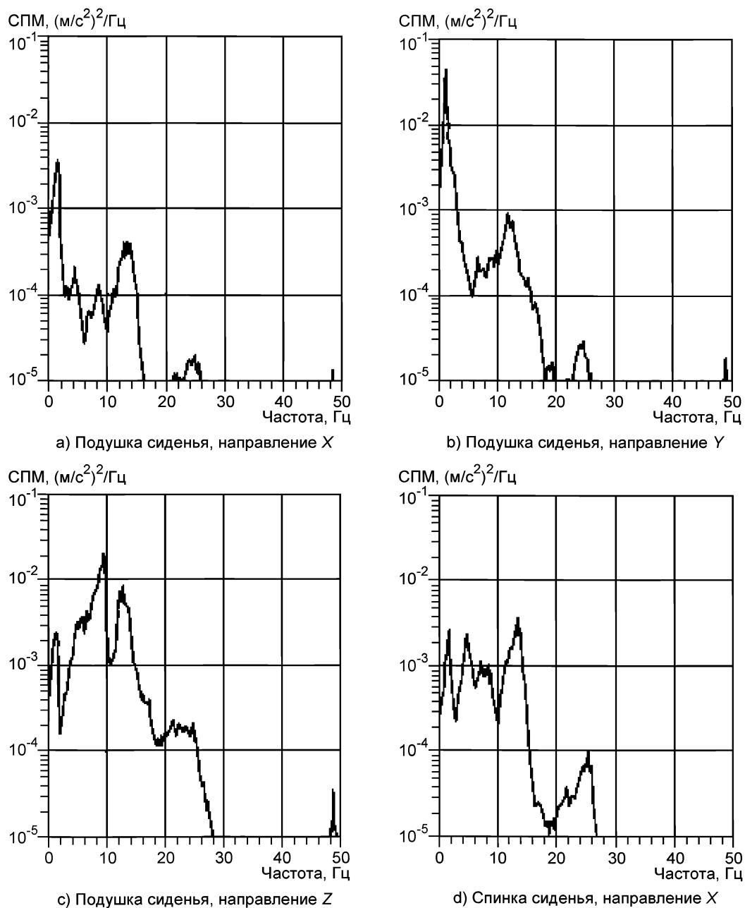
Рисунок А.2 — Спектральные плотности мощности (СПМ) корректированного сигнала ускорения на подушке и спинке сиденья, полученные по результатам измерений в зоне 1
