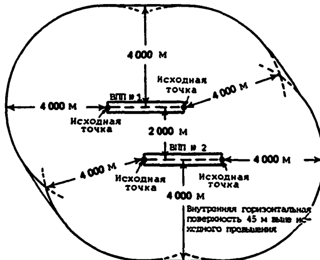
Рис. 1-2. Составная внутренняя горизонтальная поверхность двух параллельных ВПП (кодový номер ВПП - 4)
