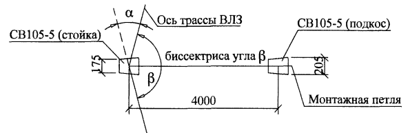
Схема установки стойки и подкоса
