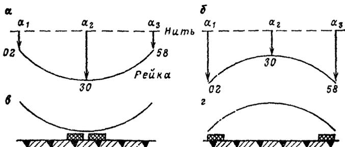
Рис. 7. Определение и исправление стрелки прогиба рейки
