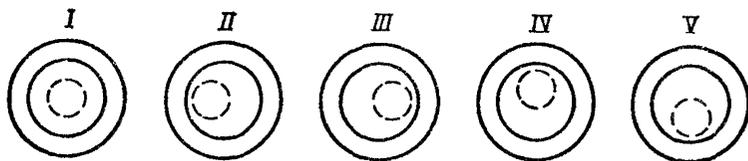
Рис. 5. Положения пузырька установочного уровня при наклоне оси нивелира подъемными винтами
