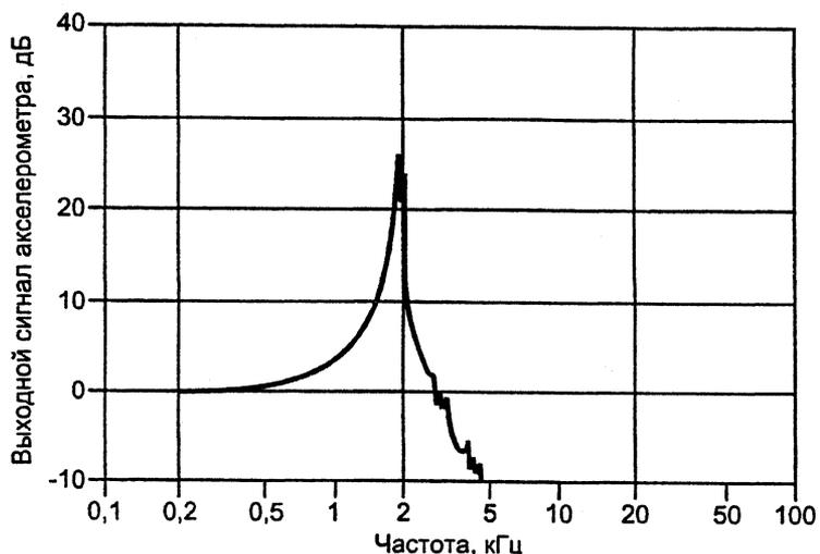
Рисунок 8 — Типичная частотная характеристика акселерометра с щупом
