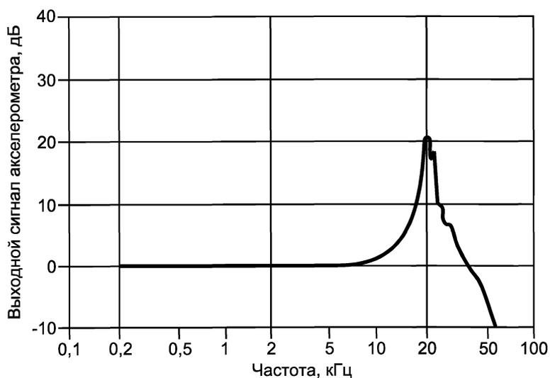
Рисунок 9 — Частичная частотная характеристика акселерометра на магните
