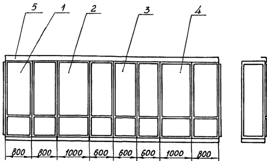
1 - щит панельный с каркасом двухсекционный, закрытый слева, исполнение I; 2 - щит панельный с каркасом, исполнение I;
