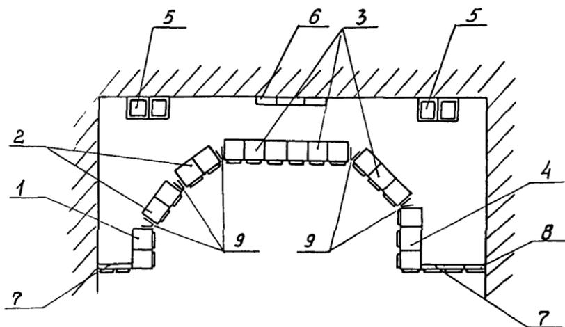
1 - щит панельный с каркасом двухсекционный, закрытый с левой стороны - ЩПК-2-ЗЛ; 2 - щиты панельные с каркасом двухсекционные - ЩПК-2; 3 - щиты панельные с каркасом трехсекционные ЩПК-3; 4 - щит панельный с каркасом трехсекционный закрытый справа - ЩПК-3-ЗП; 5 - статов двухсекционный - С-2; 6 - статов плоский - СП; 7 - панель вспомогательная с дверью - ПнВ-Д; 8 - панель вспомогательная - ПнВ; 9 - вставка угловая - ВУ.
