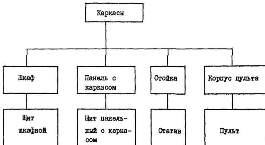
**Каркас** - жесткий, несущий объемный или плоский металлический остов, предназначенный для установки на нем панелей, дверей, крышек, поворотных или стационарных рам, деталей для монтажа приборов, аппаратов, арматуры, установочных изделий электрической и трубной проводок.
