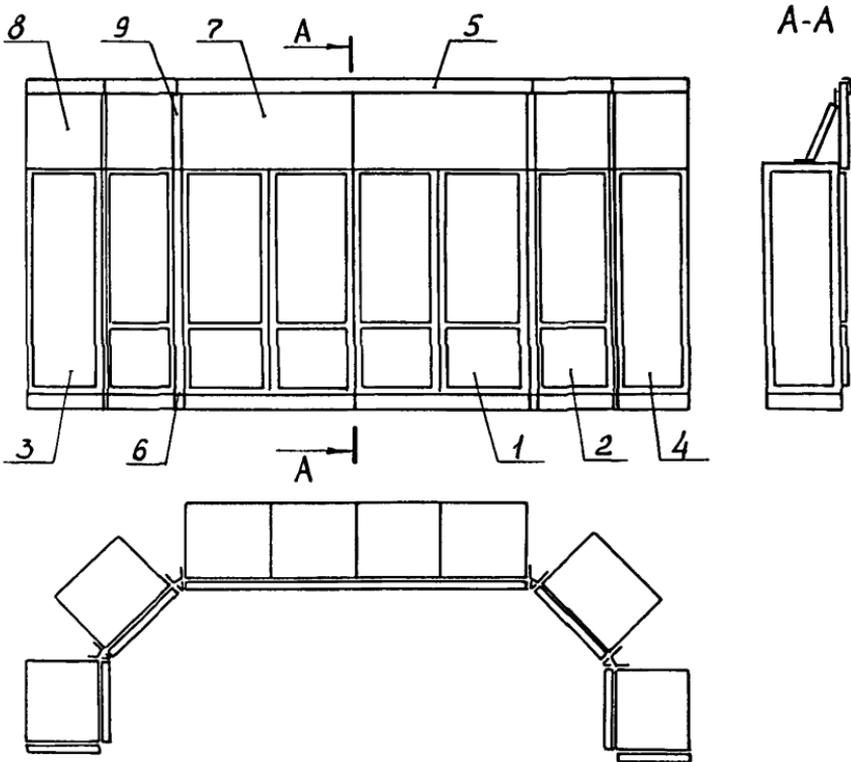
1 - щит панельный с каркасом двухсекционный, открытый с двух сторон, исполнение I; 2 - щит панельный с каркасом открытый с двух сторон, исполнение I; 3 - щит панельный с каркасом закрытый слева, исполнение I; 4 - щит панельный с каркасом закрытый справа, исполнение I; 5 - обрамление; 6 - вставка угловая; 7 - панель декоративная; 8 - панель торцевая декоративная; 9 - вставка угловая для панелей декоративных.
