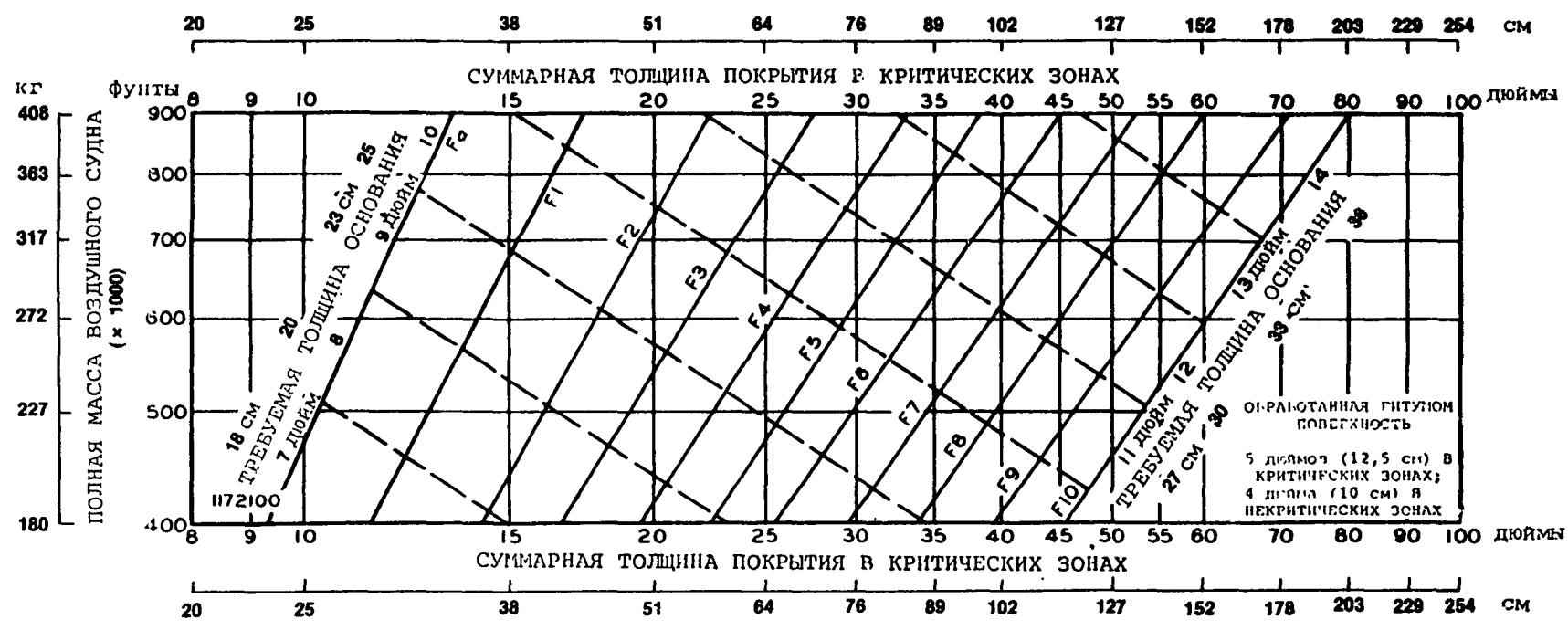
Рис. А4-11. Оценочные кривые для самолета В-747 для нежестких покрытий
