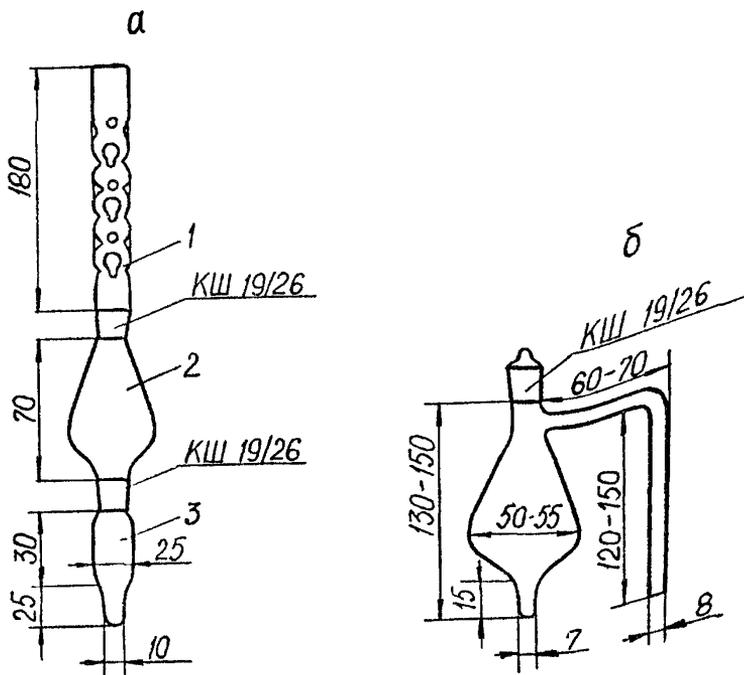
а - аппарат Кудерна-Даниша (1 - дефлегматор, 2 - средняя часть аппарата, 3 - пробирка для сбора концентрата);
