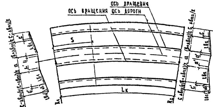
Отгон виража и уширения на клоноиде или отрезке клоноиды, имеющей односкатный поперечный профиль в начале и конце отгона виража, осуществляется прямопропорционально длине закругления. Поперечный уклон в любом сечении переходной кривой  $L_k$  определяется по формуле
