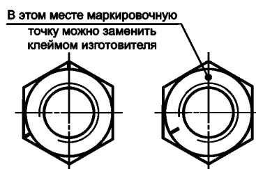
Рисунок 4 — Примеры маркировки кодовым символом (система циферблата)
