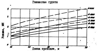
Графиям составлены для двух случает: при непосредственном удажения грунта (сплошная линия) и при удалении грунта через каждне два метра проходям (пунктирная линия).
