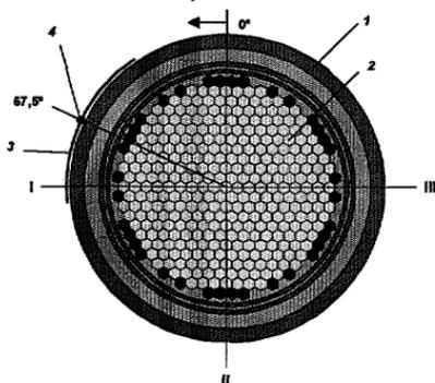
Рис. 2. Схема размещения облучательного устройства у корпуса ВВЭР-440 с кассетами-экранами:
