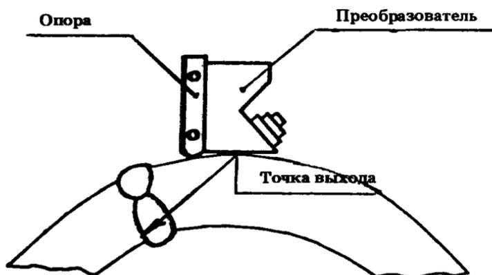
Рис. П2.7. Опора для преобразователя
