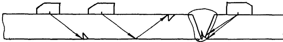
Рис. П9.1. Схема контроля сварных соединений труб толщиной  $< 15$  мм: а — настройка скорости развертки:  $D_1$  — сигнал от нижней зарубки,  $D_2$  — от верхней; б — обнаружение сигнала от надкорневых несплошностей и провисаний:  $D$  — сигнал от несплошности;  $\Pi$  — сигнал от провисания, совпадающий с сигналом  $D$  по координате; в — разметка экрана после скорости развертки
