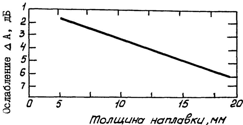
Рис. 12. Ослабление  $\Delta A$  донного сигнала за счет затухания в наплавке из аустенитной стали различной толщины при контроле нормальным преобразователем:  $f = 1,8-2,5$  МГц (для  $f = 2,0$  МГц затухание равно  $0,35$  дБ/мм)
