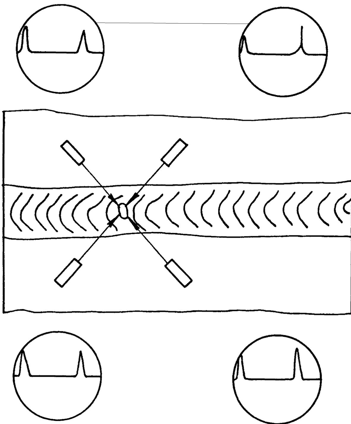
Рис. П9.8. Выявление отдельных шлаковых включений и пор в сварных соединениях сосудов
