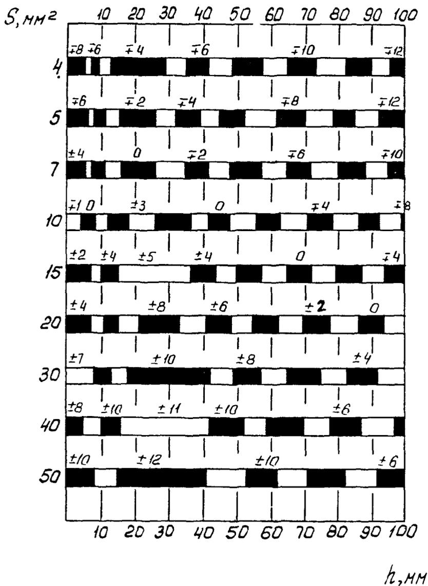
Рис. П4.1. Разность между опорным (по СО-2) и браковочным уровнями чувствительности при контроле сварных соединений преобразователями ИЦ, ПИЦ-1,0-40<sup>0</sup> (D пьезоэлемента 18 мм, коэффициент затухания 0,001 мм<sup>-1</sup>)
