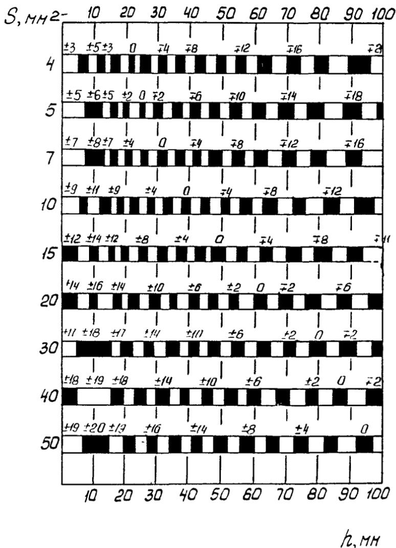
Рис. П4.3. Разность между опорным (по СО-2) и браковочным уровнями чувствительности при контроле сварных соединений преобразователями ИЦ, ПИЦ-1,8-65° (D пьезоэлемента 18 мм, коэффициент затухания  $0,001 \text{мм}^{-1}$ )
