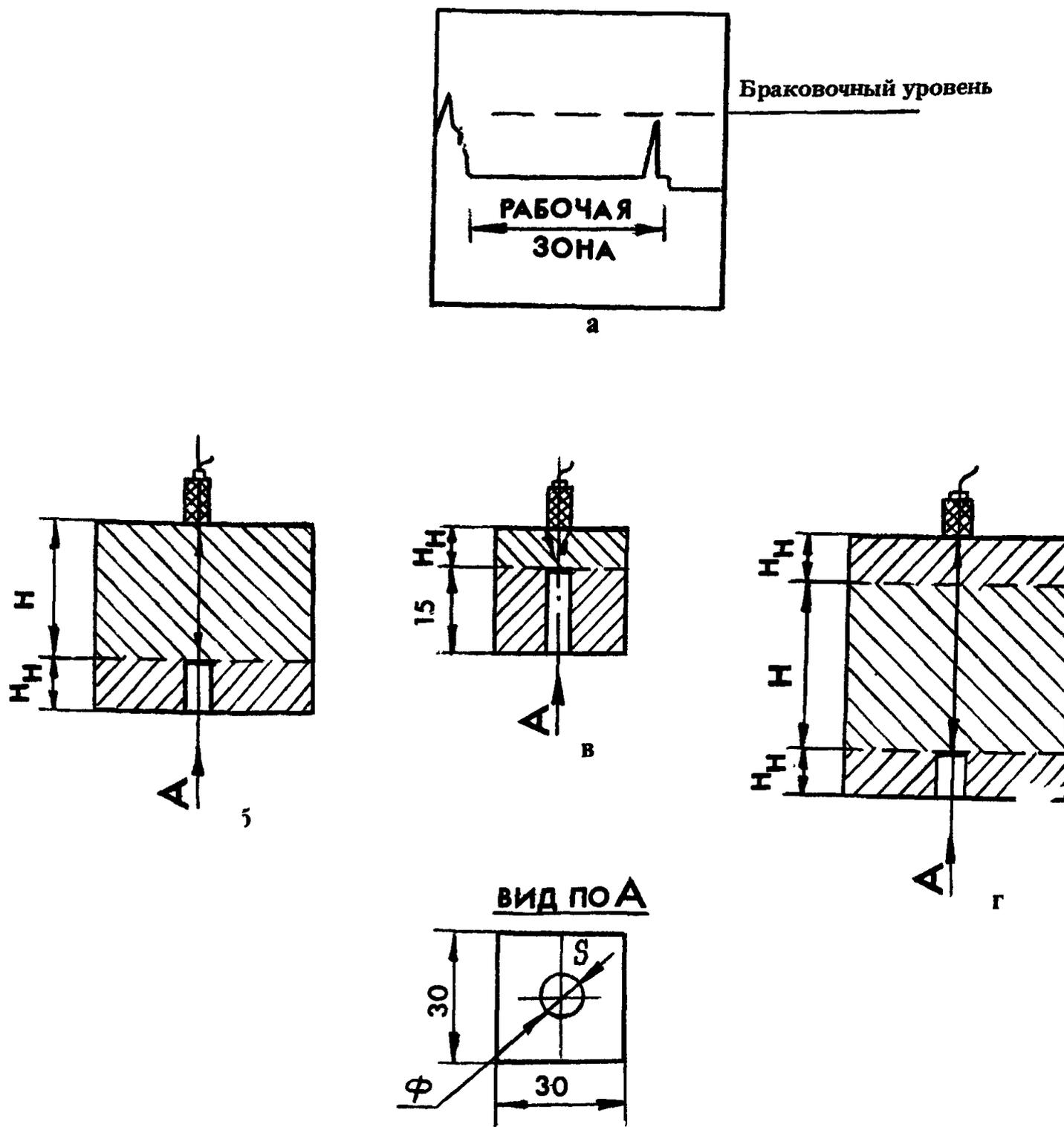
Рис. 8. СОП для контроля антикоррозионной наплавки: а — схема настройки дефектоскопа; б — контроль со стороны основного металла; в — контроль со стороны наплавки; г — контроль через наплавку;  $\phi$  — диаметр плоскостонного отверстия; S — площадь плоскостонного отверстия; H — толщина основного металла;  $H_H$  — толщина наплавки
