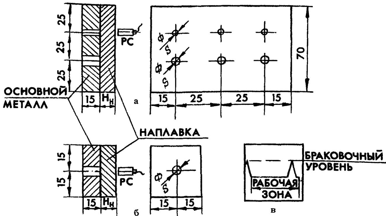
Рис. 6. СОП для контроля РС-преобразователем перлитной (а) и аустенитной (б) наплавки кромок и схема настройки дефектоскопа (в):  $H_H$  — толщина наплавки;  $\varnothing$  — диаметр плоскодонного отверстия;  $S$  — площадь дна плоскодонного отверстия ( $\varnothing$  и  $S$  — маркировать)
