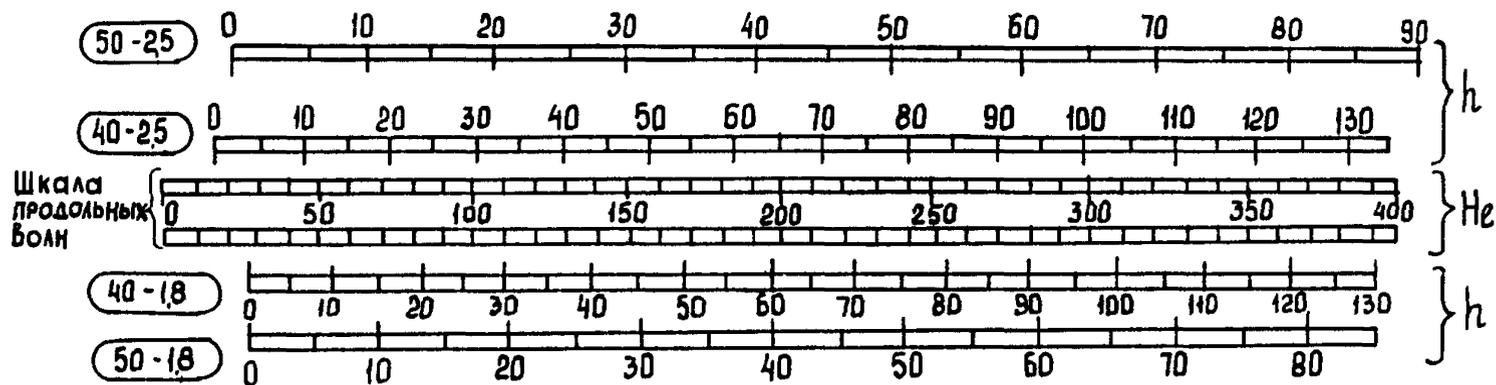
Рис. П5.2. Совмещенные шкалы расстояний (мм): **50-2,5** —  $50^\circ$  — угол призмы; 2,5 МГц — частота
