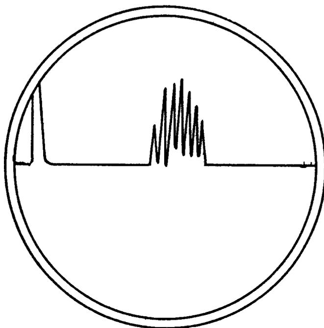
Рис. П9.9. Выявление рыхлости в сварных соединениях сосудов
