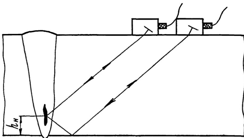
Рис. П7.2. Зона непровучивания ( $h_n$ ) при измерении коэффициента формы несплошности
