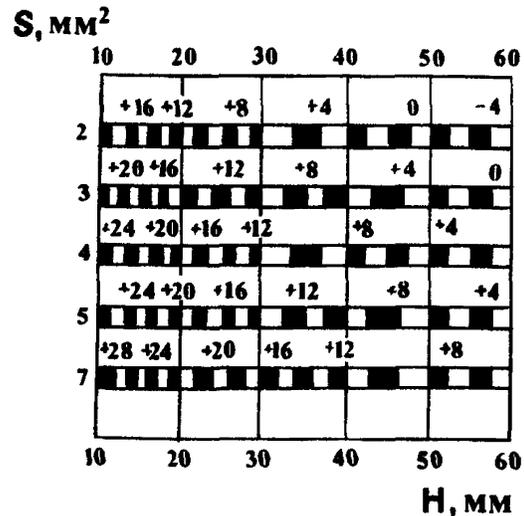
Рис. П4.15. Разность между браковочным и опорным (по СО-2) уровнями чувствительности при контроле сварных соединений толщиной 12–60 мм [коэффициент затухания  $\leq 0,002 \text{ мм}^{-1}$ , преобразователь ПРИЗ-Д6 П121-5-65<sup>о</sup> (М) ]
