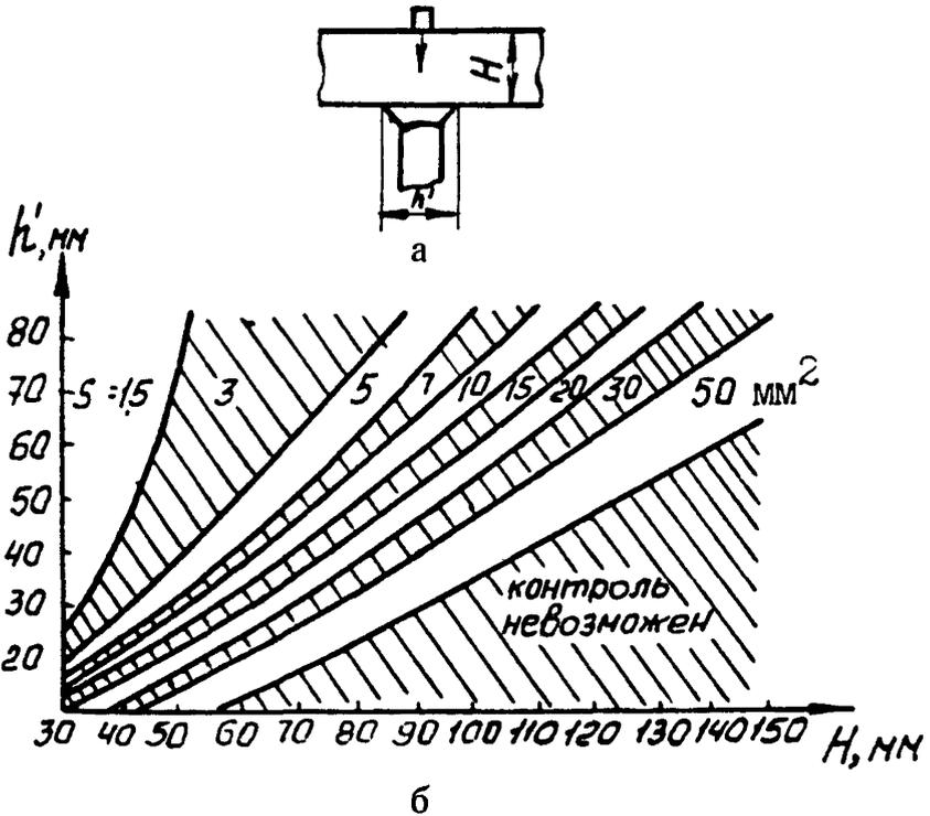
Реализуемая чувствительность  $S$  ( $\text{мм}^2$ ) при контроле швов тавровых сварных соединений со стороны основного элемента преобразователями с волновым размером  $K_a = 15 \pm 1,5$  ( $K$  — волновое число,  $a$  — радиус пьезоэлемента, при  $K_a \neq 15 \pm 1,5$  возможность контроля следует определять экспериментально): а — схема контроля; б — график для расчета
