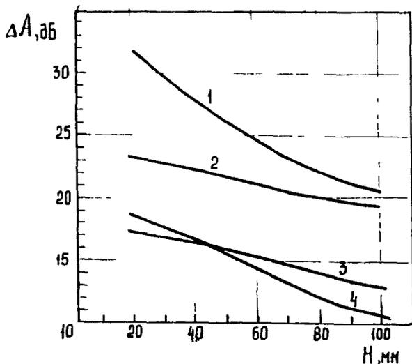
Рис. П5.3. Соотношение первого донного сигнала  $A_{\infty}$  продольной волны к эхо-сигналу  $A$  поперечной волны в СО-2 при прозвучивании НП: 1 — угол призмы  $50^{\circ}$ , частота 2,5 МГц; 2 — угол призмы  $50^{\circ}$ , частота 1,8 МГц; 3 — угол призмы  $40^{\circ}$ , частота 1,8 МГц; 4 — угол призмы  $40^{\circ}$ , частота 2,5 МГц
