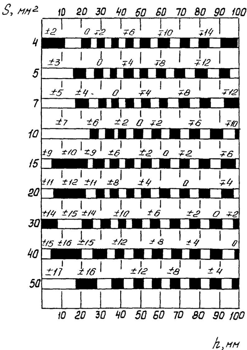
Рис. П4.7. Разность между опорным (по СО-2) и браковочным уровнями чувствительности при контроле сварных соединений преобразователем ПРИЗ-Д5-1,8-50<sup>0</sup> (коэффициент затухания 0,001 мм<sup>-1</sup>)
