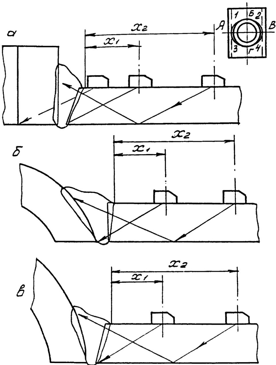
Рис. П9.6. Схемы контроля углового кольцевого сварного соединения:
