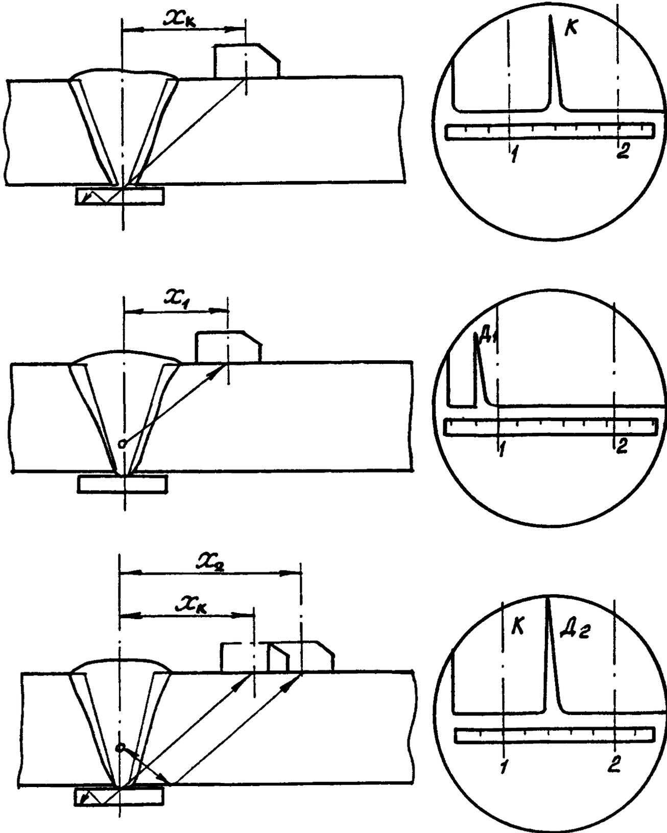
Рис. П9.3. Схемы обнаружения подкладного кольца и надкорневой несплошности: 1 и 2 — положение сигналов от углового отражателя; К — сигнал от подкладного кольца;  $D_1$  и  $D_2$  — сигналы от надкорневой несплошности, обнаруженные прямым или однажды отраженным лучом;  $x_k$ ,  $x_1$  и  $x_2$  — расстояния между серединой шва и точкой ввода преобразователя
