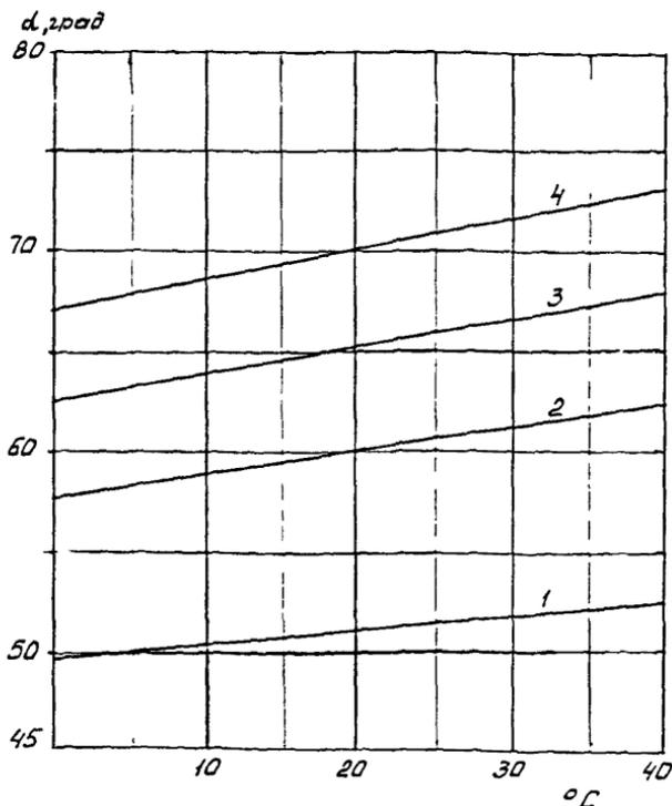
Рис. 9. Зависимость угла ввода ( $\alpha$ ) от температуры для преобразователя с номинальными углами ввода  $\alpha = 51^\circ$  ( $\beta = 40^\circ$ ) (1);  $60^\circ$  (2);  $65^\circ$  ( $\beta = 50^\circ$ ) (3) и  $70^\circ$  (4)
