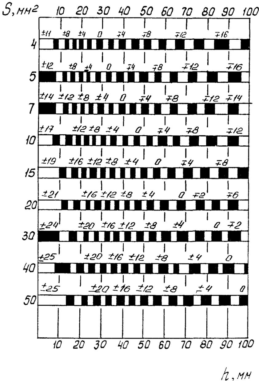
Рис П4.8 Разность между опорным (по СО-2) и браковочным уровнями чувствительности при контроле сварных соединений преобразователем ПРИЗ-Д5-1,8-65<sup>0</sup> (коэффициент затухания 0,001 мм<sup>-1</sup>)
