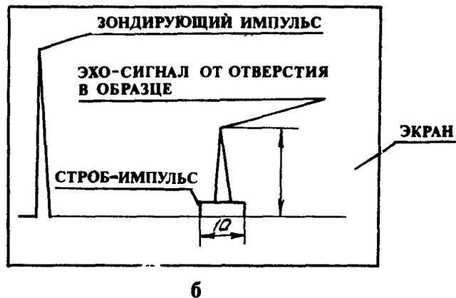
Рис. ПЗ.2. СОП (а) и схема настройки скорости развертки и чувствительности (б)
