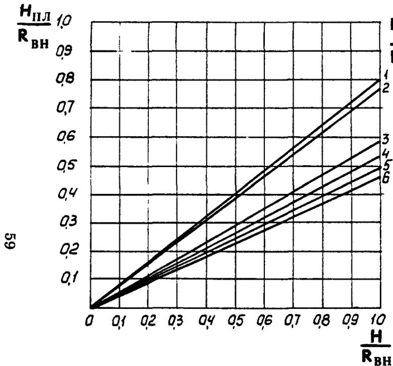
Рис. П2.3. Эквивалентная толщина плоского сварного соединения при контроле продольных швов с внутренней стороны: для ПЭП с углом ввода  $40^\circ$  (1);  $50^\circ$  (2);  $65^\circ$  (3);  $68^\circ$  (4);  $70^\circ$  (5);  $72^\circ$  (6)
