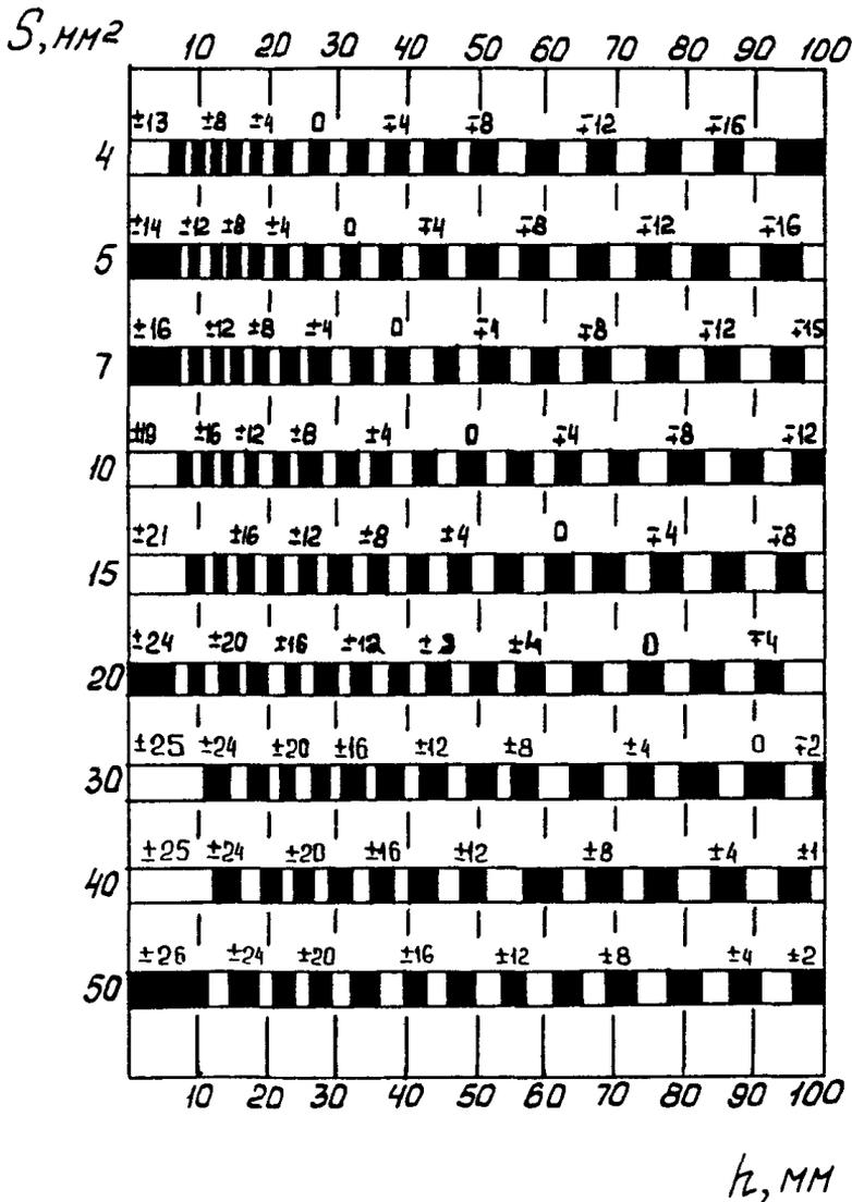
Рис. П4.10. Разность между опорным (по СО-2) и браковочным уровнями чувствительности при контроле сварных соединений преобразователями ИЦ, ПНЦ-2,5-65° (D 12 мм, коэффициент загужания 0,001 мм<sup>-1</sup>)
