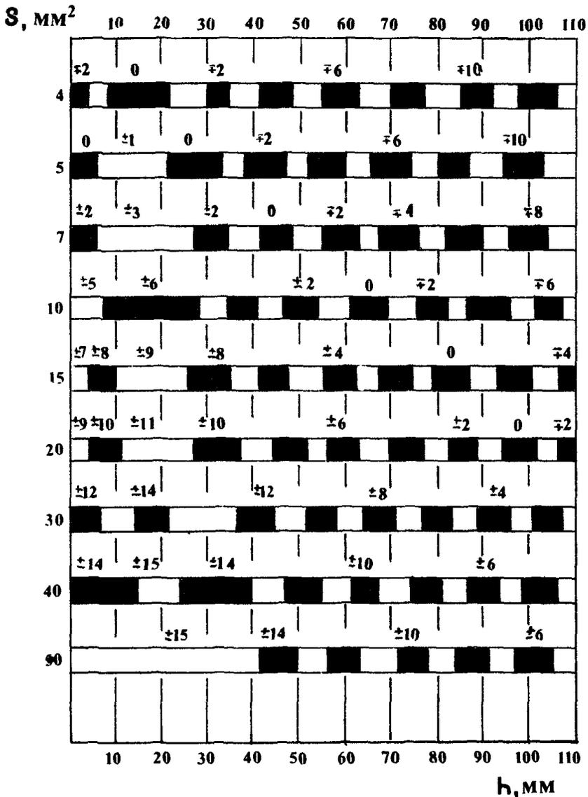
Рис. П4.11. Разность между опорным (по СО-2) и браковочным уровнями чувствительности при контроле сварных соединений преобразователем ПРИЗ-Д5-2,5-50<sup>0</sup> (размер пьезоэлемента 12 x 16 мм<sup>2</sup>, коэффициент затухания 0,001 мм<sup>-1</sup>)
