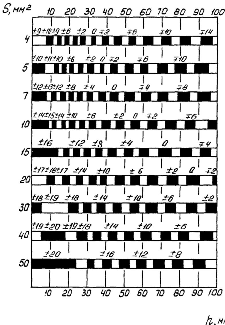
Рис. П4.9. Разность между опорным (по СО-2) и браковочным уровнями чувствительности при контроле сварных соединений преобразователями ИЦ, ПИЦ-2,5-50<sup>0</sup> (D пьезоэлемента 12 мм, коэффициент затухания 0,001 мм<sup>-1</sup>)
