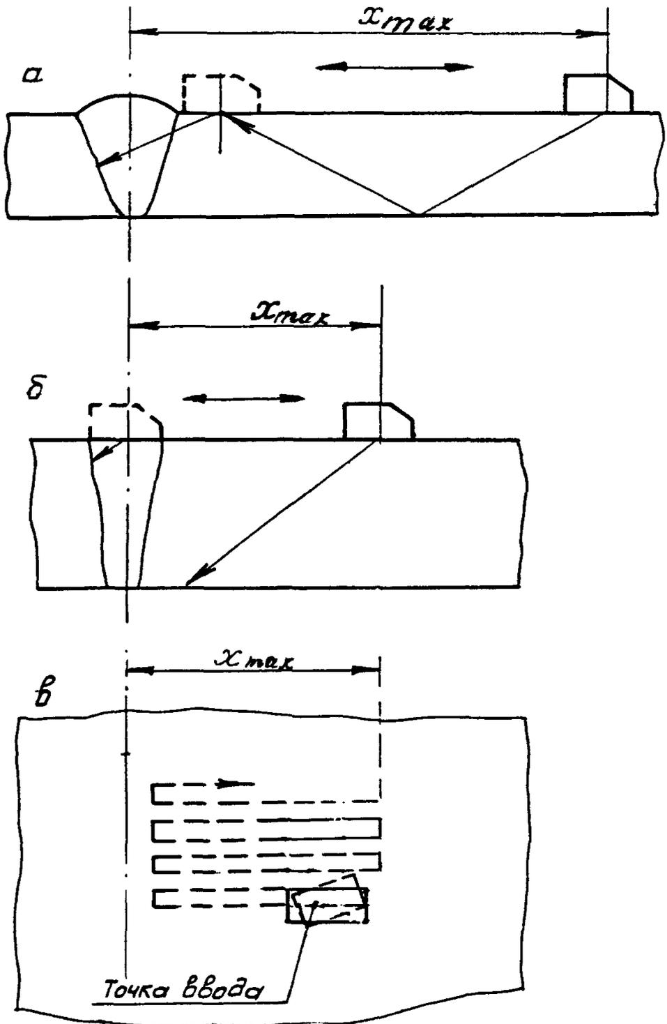
Рис. 14. Схемы сканирования сварного соединения: а — при контроле сварных соединений толщиной < 60 мм; б — то же толщиной 60 мм и более; в — траектория сканирования;  $x_{max}$  — максимальное удаление ПЭП от шва
