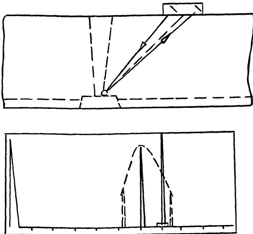
Рис. П14.6. Схема обнаружения объемных несплошностей
