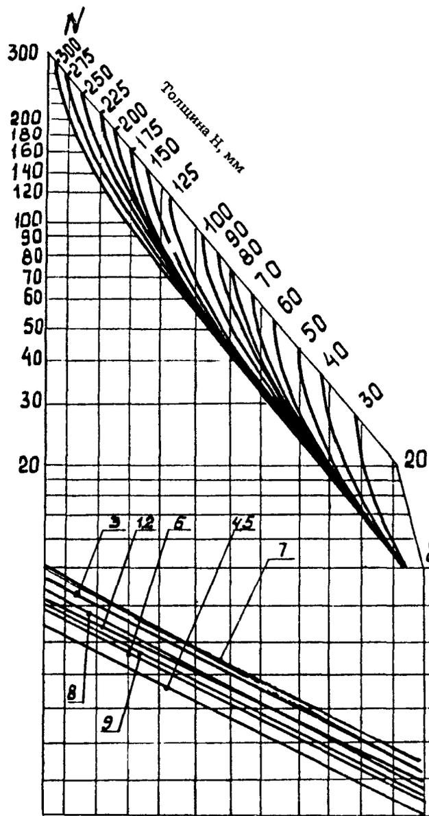
Рис 13 ARД-диаграмма схемы "тандем" (ARДТ-диаграмма) · 1 — ПРИЗ 1,8—30°, 2 — ПРИЗ 1,8—40°, 3 — ПРИЗ 1,8—50°, 4 — ПРИЗ 2,5—30°, 5 — ПРИЗ 2,5—40°, 6 — ПРИЗ 2,5—50°, 7 — ИЦ 1,8—50° (ПНЦ), 8 — ИЦ 1,8—30°, 1,8—40° (ПНЦ), WB 35—N2, MWB 35—N2, 9 — ИЦ 2,5—30°, 40°, 50° (ПНЦ), WB 45—N2, MWB 45—N2
