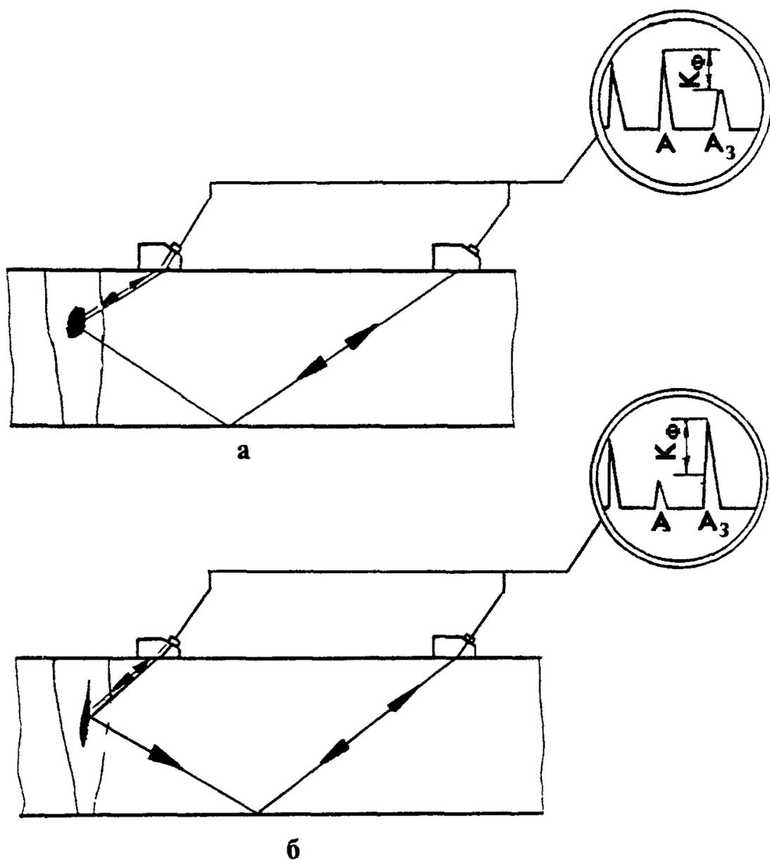
Рис. П7.1. Коэффициент формы объемных (а) и плоскостных (б) несплошностей: — — — — —  $A$ ; ————— —  $A_3$
