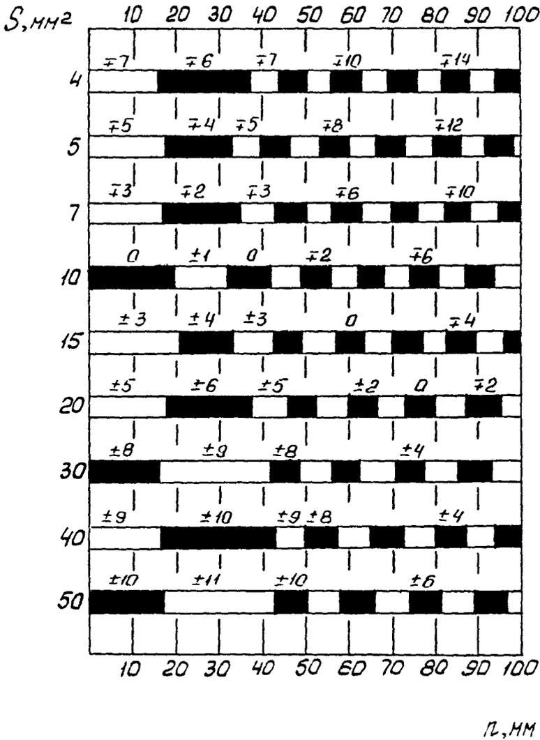
Рис. П4.6. Разность между опорным (по СО-2) и браковочным уровнями чувствительности при контроле сварных соединений преобразователем ПРИЗ-Д5-1,8-40<sup>0</sup> (размер пьезоэлемента 12 x 16 мм<sup>2</sup>, коэффициент затухания 0,001 мм<sup>-1</sup>)
