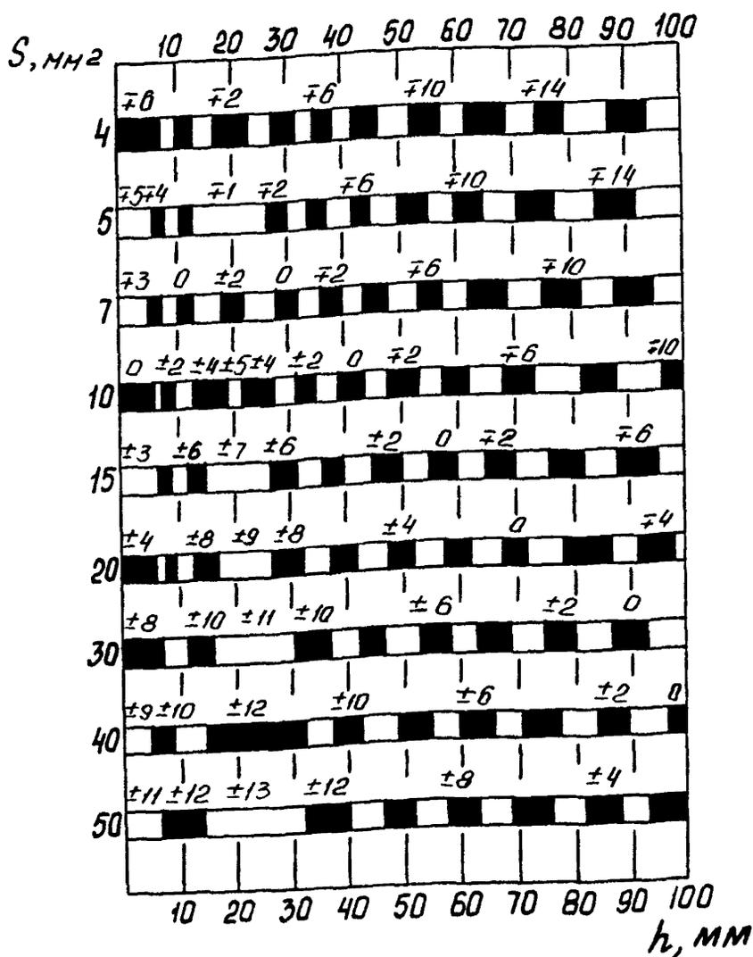
Рис. П4.4. Разность между опорным (по СО-2) и браковочным уровнями чувствительности при контроле сварных соединений преобразователями ИЦ, ПИЦ-1,8-50<sup>0</sup> (коэффициент затухания 0,001 мм<sup>-1</sup>)
