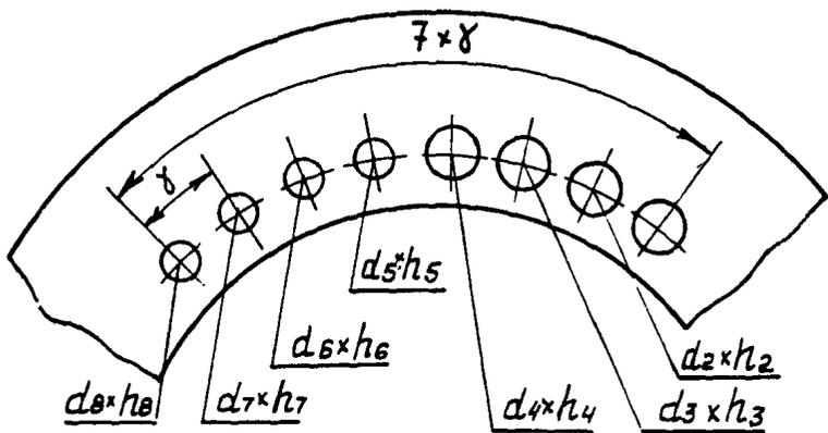
Рис. П6.1. СОП для настройки дефектоскопа
