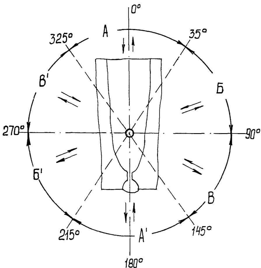
Рис. 1. Схема определения степени контроледоступности сварного соединения:  $\odot$  – контролируемый элемент сварного соединения;  $\rightleftarrows$  – направления прозвучивания (цифрами обозначены углы озвучивания, буквами – секторы обзора)
