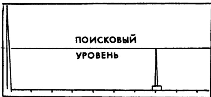
Рис. П14.7. Схема измерения условной протяженности дефекта
