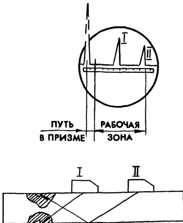
Рис. 5. Схема настройки развертки по угловым отражателям
