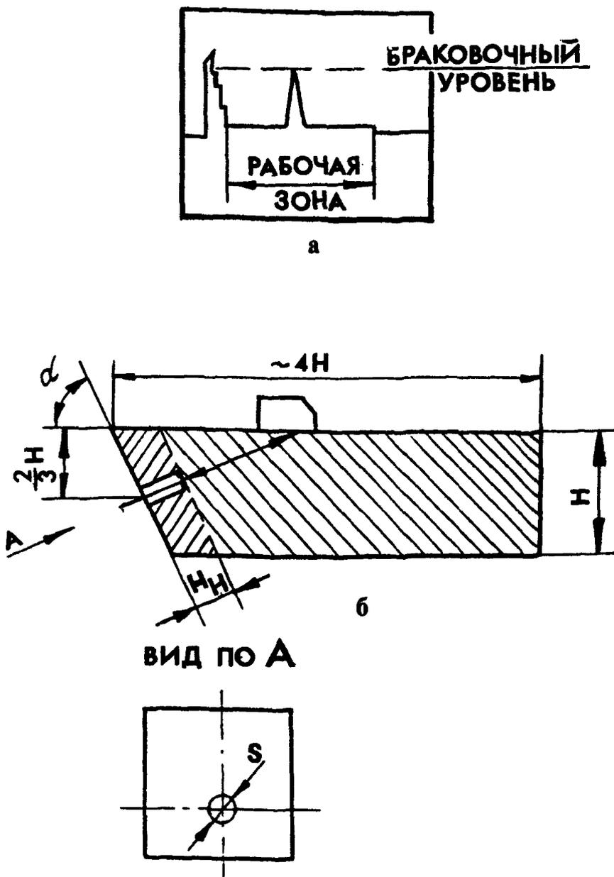
Рис. 7. Схема настройки дефектоскопа (а) и СОП для контроля НП перлитной и аустенитной наплавки (б):  $S$  — площадь плоскодонного отверстия;  $H$  — толщина образца;  $H_n$  — глубина плоскодонного отверстия, равная толщине наплавки
