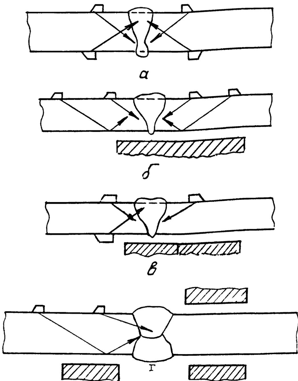
Рис. 2. Схемы контроля стыковых сварных соединений наклонными преобразователями: а — при толщине 60 мм и более не зависимо от наличия усиления шва; б — при толщине  $\leq 60$  мм не зависимо от наличия усиления шва; в — при толщине до 100 мм с ограниченным доступом; г — при ограничении доступа не зависимо от толщины
