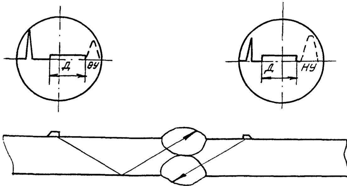
Рис. П9.10. Схема обнаружения эхо-сигналов от неровностей формирования усиления шва при контроле стыковых (угловых, тавровых, крестообразных) сварных соединений при контроле со стороны привариваемого элемента: Д — зона появления эхо-сигналов от несплошностей шва; ВУ, НУ — зона появления эхо-сигналов от неровностей верхнего и нижнего усиления шва соответственно
