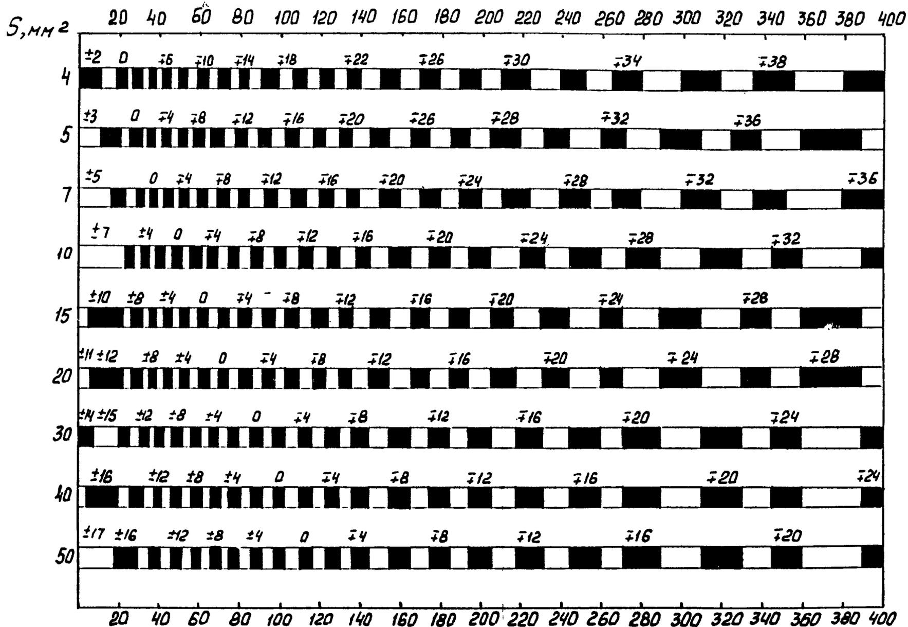
Рис. П4.5. Разность между опорным (по СО-2) и браковочным уровнями чувствительности при контроле сварных соединений преобразователем ПРИЗ-Д5-1,8-50° (размер пьезоэлемента 12 x 16 мм<sup>2</sup>, коэффициент затухания 0,001 мм<sup>-1</sup>)
