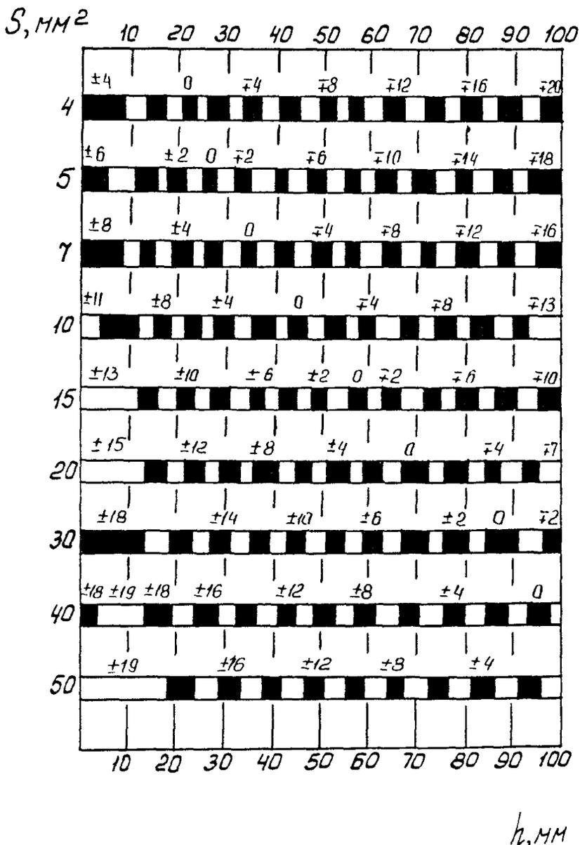
Рис. П4.12 Разность между опорным (по СО-2) и браковочным уровнями чувствительности при контроле сварных соединений преобразователем ПРИЗ-Д5-2,5-65<sup>0</sup> (размер пьезоэлемента 12 x 16 мм<sup>2</sup>, коэффициент заглухания 0,001 мм<sup>-1</sup>)
