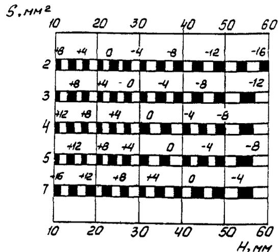
Рис. П4.13. Разность между браковочным и опорным (по СО-2) уровнями чувствительности при контроле сварных соединений толщиной 12–60 мм [коэффициент затухания  $\leq 0,002 \text{ мм}^{-1}$ , преобразователь ПРИЗ-Д6 П121-2,5-50° (М-001)]
