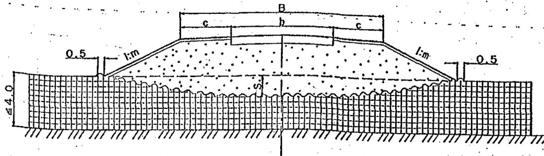
РАСХОД ГЕОТЕКСТИЛЯ НА 1.0 м ЗЕМПОЛОТНА, м<sup>2</sup>
