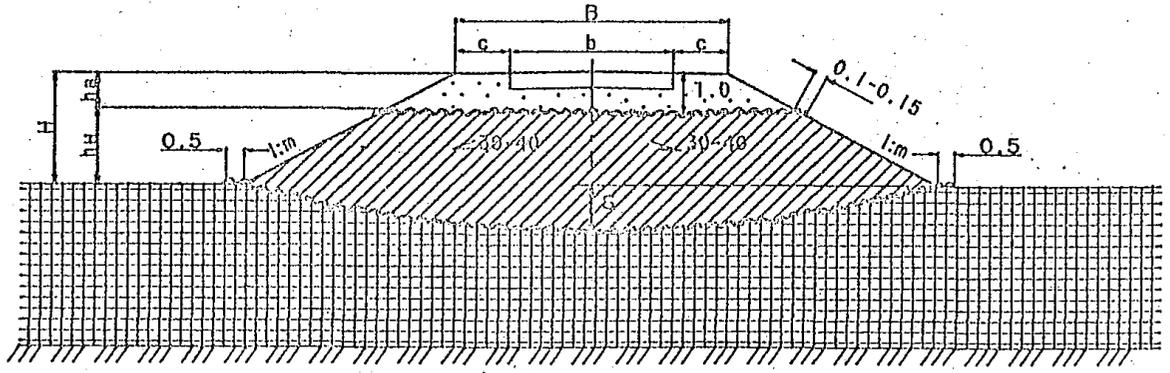
1. ТИП 3-С ПРИМЕНЯЕТСЯ НА СЛАБЫХ ОСНОВАНИЯХ I-П СТРОИТЕЛЬНЫХ ТИПОВ ДЛЯ АВТОМОБИЛЬНЫХ ДОРОГ III-V КАТЕГОРИЙ, ДЛЯ МЕЖПРОМЫСЛОВЫХ ДОРОГ, НЕФТЯНЫХ И ГАЗОВЫХ НЕСТОРОЖДЕНИЙ.
