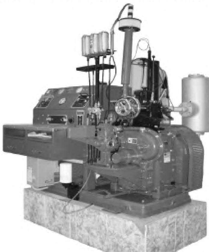
Рисунок 2 — Установка CFR F-5 для определения цетанового числа
