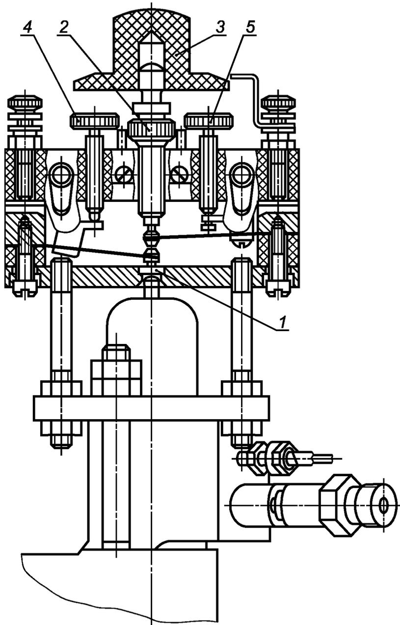
1 — зазор между нижней пластиной и штоком; 2 — центральный винт;
