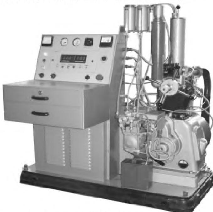
Рисунок 1 — Установка ИДТ-90 для определения цетанового числа
