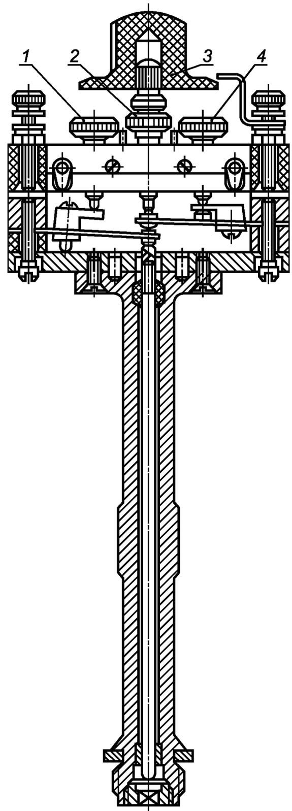
1, 4 — установочные винты; 2 — центральный винт; 3 — регулировочный винт
