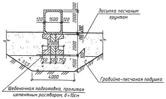
1. Конструкция трубы принята по типовой документации серии 3.501.1-177.93 "Трубы водопропускные железобетонные прямоугольные сборные для автомобильных и железных дорог".
