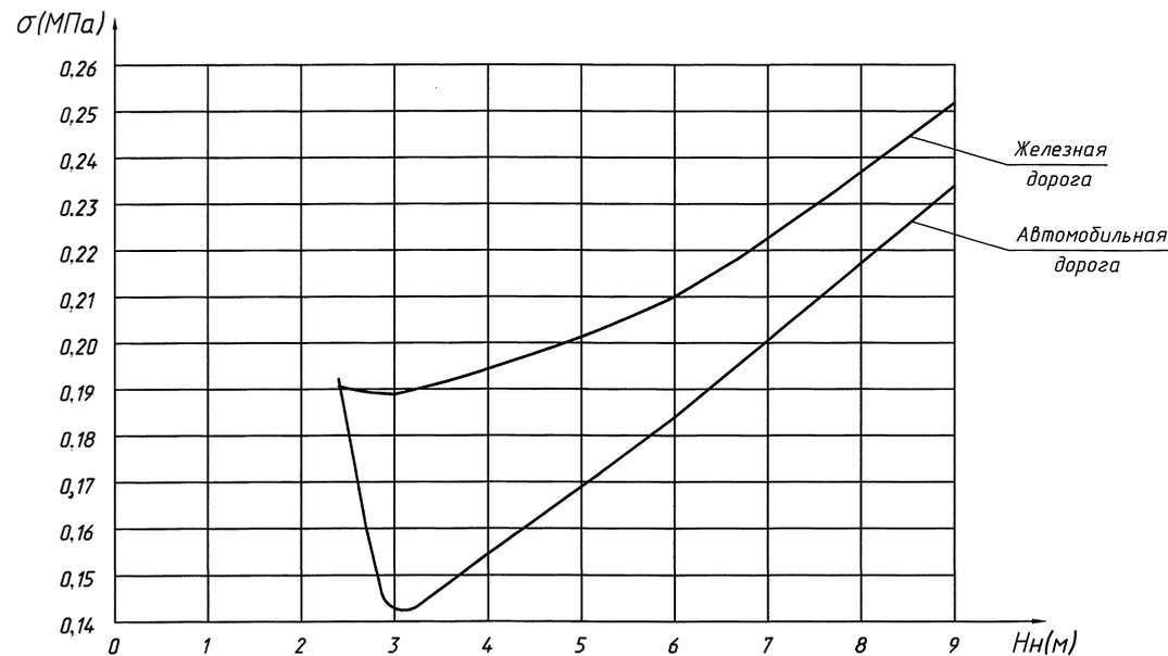
1. График давления на грунт приведен для средней секции фундамента.
