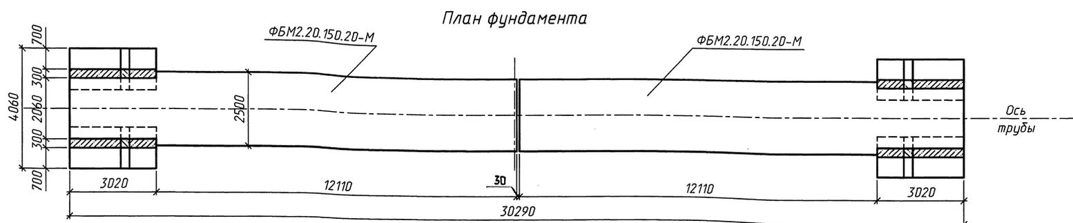
1. Конструкция трубы принята по типовой документации серии 3.501.1-177.93 "Трубы водопропускные железобетонные прямоугольные сборные для автомобильных и железных дорог".
