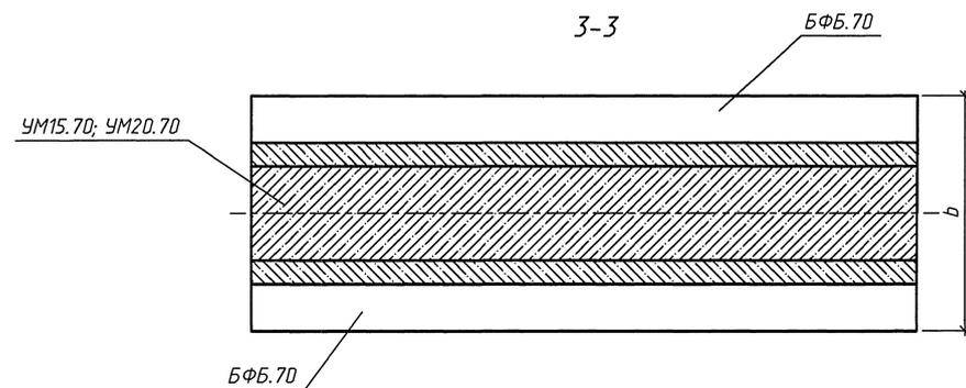
1.Материал блоков и монолитных участков - бетон класса В30, морозостойкостью F200-300 в зависимости от климатических условий района строительства.
