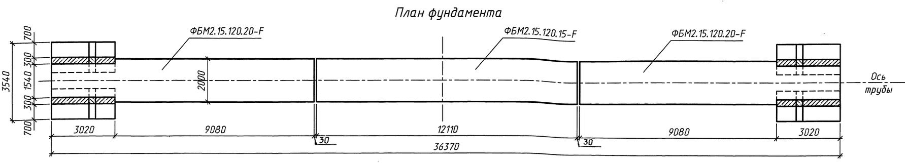
1. Конструкция трубы принята по типовой документации серии 3.501.1-177.93 "Трубы водопропускные железобетонные прямоугольные сборные для автомобильных и железных дорог".
