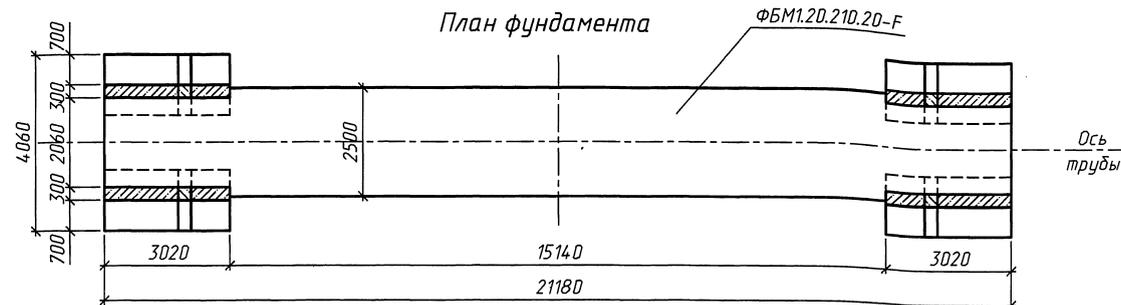
1. Конструкция трубы принята по типовой документации серии 3.501.1-177.93 "Трубы водопропускные железобетонные прямоугольные сборные для автомобильных и железных дорог".
