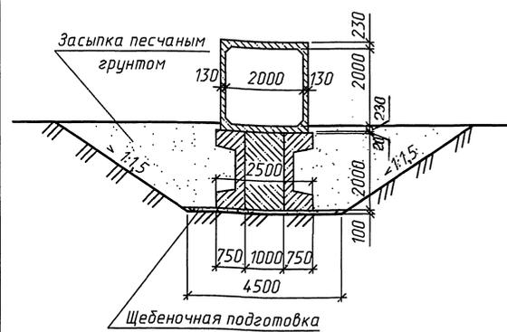
1. Конструкция трубы принята по типовой документации серии 3.501.1-177.93 "Трубы водопропускные железобетонные прямоугольные сборные для автомобильных и железных дорог".
