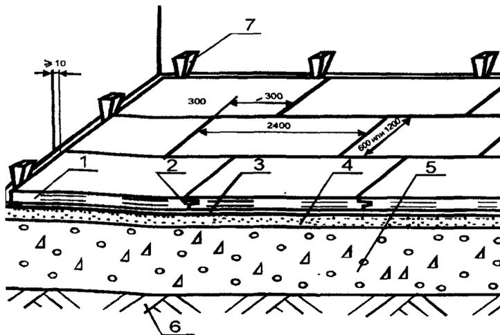
**5.56.** Нарезка деформационных швов осуществляется после высыхания клея ручной циркулярной пилой с отрегулированной опорной плитой таким образом, чтобы глубина пропила соответствовала толщине плиты. Ширина деформационного шва должна составлять 5—10 мм.
