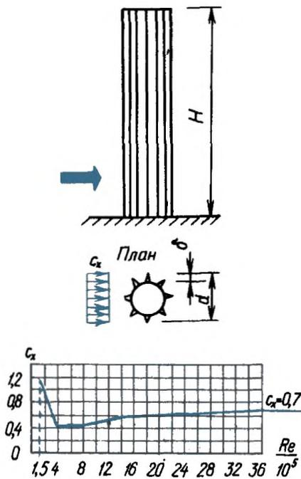
Схема применяется для сооружений с круговой цилиндрической боковой поверхностью (резервуары, градирни, башни, дымовые трубы), а также для круглых трубчатых и сплошных элементов в сквозных сооружениях, проводов, тросов.
