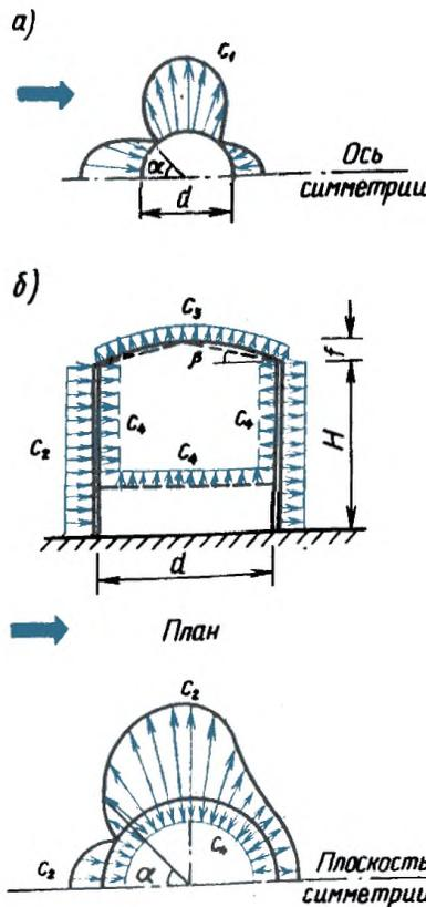
Схемы применяются для сфер (а) и для сооружений с круговой цилиндрической боковой поверхностью (резервуары, градирни, башни, дымовые трубы) с покрытиями или без покрытий (б).
