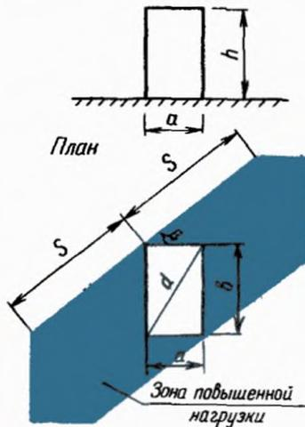
Схема относится к участкам возле возвышающихся над кровлей вентиляционных шахт, башен и других надстроек с диагональю их основания  $d$  не более 15 м.
