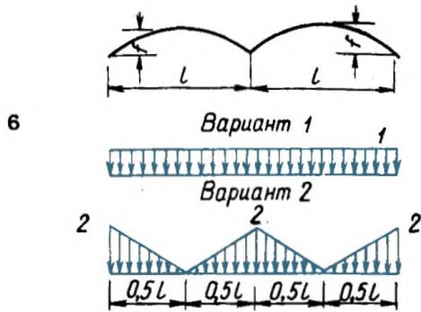
Приведенные схемы (для двухпролетных зданий со сводчатыми и близкими к ним по очертанию покрытиями) распространяются на покрытия многопролетных зданий с подобным профилем.
