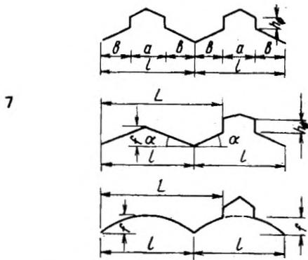
В двух- и многопролетных зданиях схемы снеговой нагрузки для пролетов с фонарем принимаются в соответствии с указаниями п. 3; для пролетов без фонаря — пп. 5 и 6.
