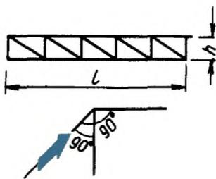
Коэффициент лобового сопротивления  $c_\phi$  для плоской фермы определяется по формуле
