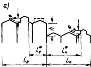
Снеговая нагрузка на верхнее покрытие принимается в соответствии с указаниями пп. 1–7, а на нижнее — как более неблагоприятная из схем пп. 1–7 и схем настоящего пункта.
