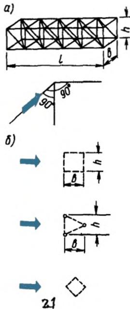
Для пространственной фермы (а) и решетчатых башен (б) коэффициент лобового сопротивления  $c_{пр}$  определяется по формуле
