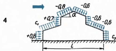
Схемы применяются для зданий с продольными фонарями. Значения  $c_1$  и  $c_3$  принимаются в соответствии со схемами п. 2. Значение коэффициента давления для торцов фонарей принимается равным минус 0,6. Значение коэффициента давления  $c = -0,8$  для наветренного участка фонаря принимается при углах наклона до  $20^\circ$ .
