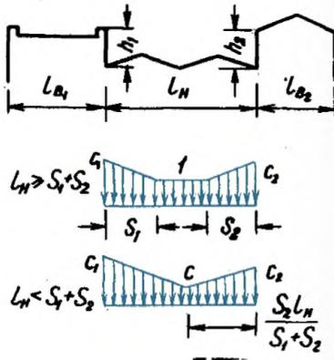
Снеговая нагрузка на верхнее и нижнее покрытие принимается по указанию п. 8. Значения  $c_1, S_1, c_2, S_2$  определяются для каждого перепада независимо, при этом:
