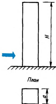
Для сооружений, квадратных и многоугольных в плане, коэффициент лобового сопротивления  $c_x$  принимается по таблице:
