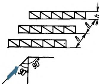
Для ряда плоских параллельно расположенных ферм коэффициент  $c'_\phi$  для первой фермы принимается по данным п. 16, для второй и последующих ферм из труб при  $Re < 4 \cdot 10^5$ , а также из профилей — по формуле
