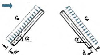
Схема применяется для вант и наклонных трубчатых элементов, расположенных в плоскости ветрового потока
