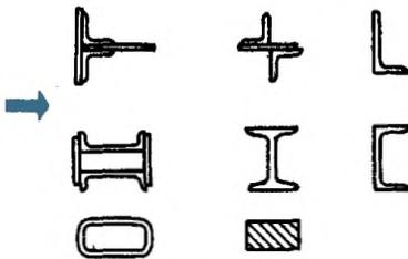
Для различных профилей решетчатых конструкций при направлении ветра, перпендикулярном оси элемента,  $c_x = 1,4$ .
