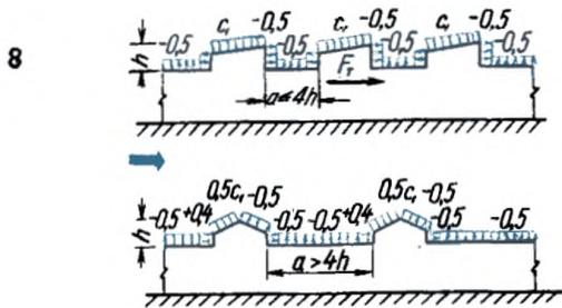
Схемы применяются для зданий, постоянно открытых с какой-либо одной стороны: полностью (при отсутствии стены на этой стороне); —частично (при наличии постоянно открытых проемов площадью не менее 30% от площади стены).
