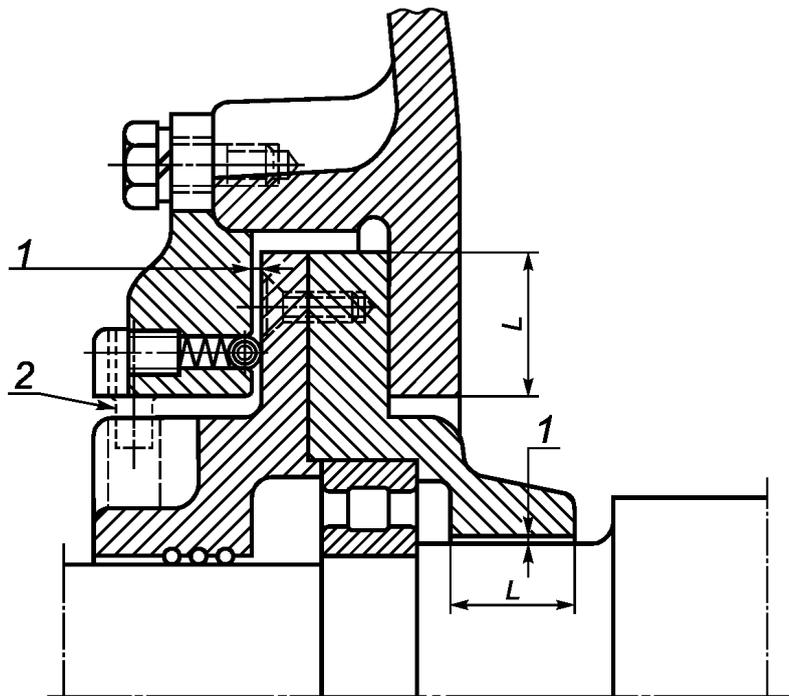
1 — зазор; 2 — стопор для предотвращения проворачивания втулки
