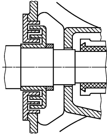
Рисунок 18 — Лабиринтное соединение для валов вращающихся электрических машин
