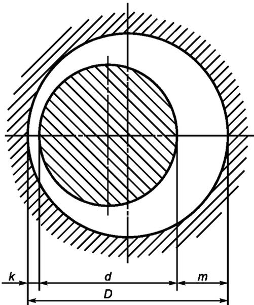
$k$  — минимальный радиальный зазор;  $m$  — максимальный радиальный зазор с учетом  $k$ ;  $D$ ,  $d$  — диаметральные зазоры
