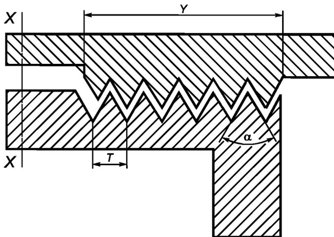
$$Y \geq 5T; \text{ испытательная длина} = \frac{Y}{1,5}; T \geq 1,25 \text{ мм}; \alpha = (60 \pm 5)^\circ$$
