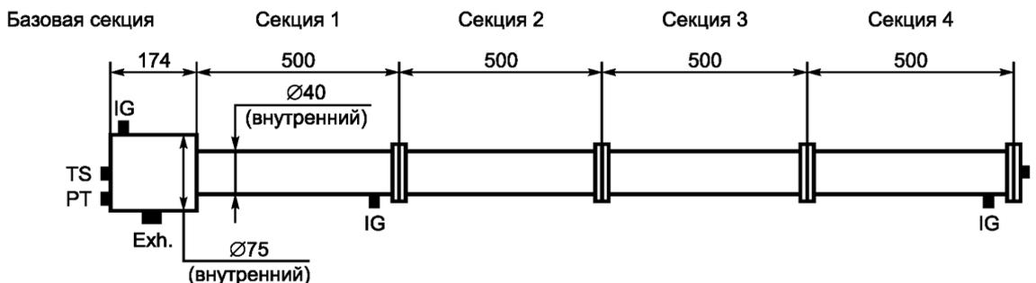
TS — местоположение испытуемого образца; I — входное отверстие; Exh. — выходное отверстие; IG — источник воспламенения; PT — датчик давления
