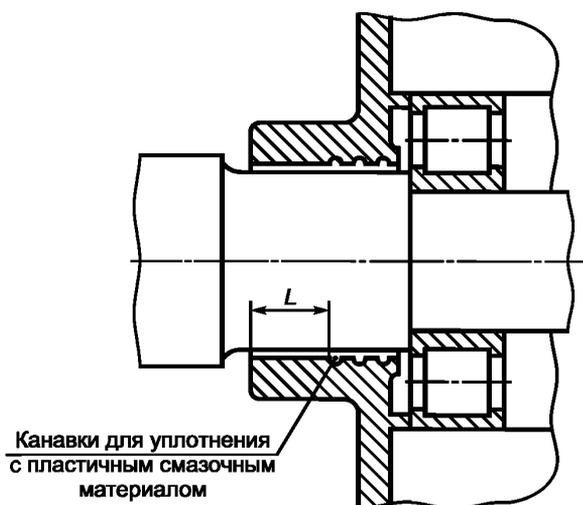
Рисунок 17 — Цилиндрическое соединение для валов вращающихся электрических машин
