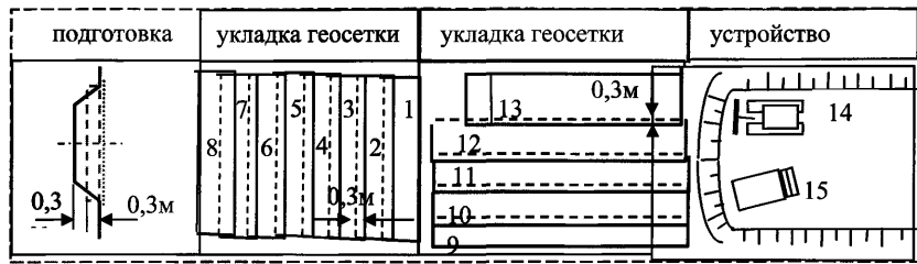
1 - 8 - рулоны (полотна) геосетки ССП «Нефтегаз» перпендикулярно оси дороги ; 9 - 13 - рулоны (полотна) геосетки ССП «Нефтегаз» параллельно оси дороги ; 14 - бульдозер; 15 - автомобиль-самосвал.
