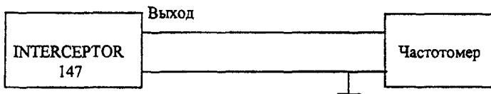
Рисунок 5.1 Схема для измерения тактовой частоты сигнала
