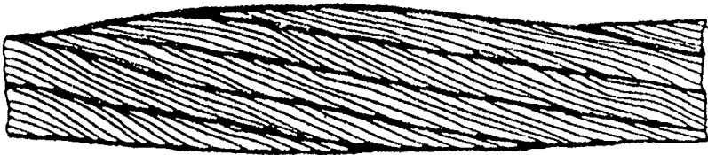
Рис. 9. Местное увеличение диаметра каната
