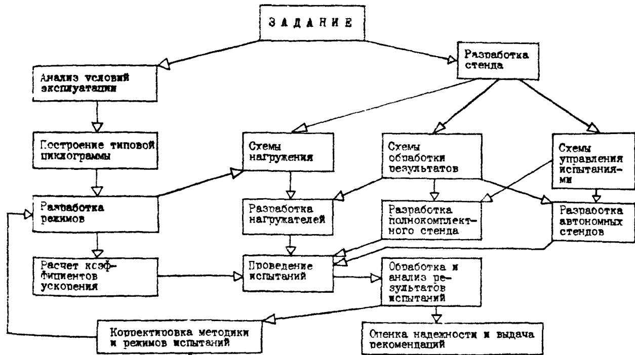
Рис.2. Примерная схема организации стендовых испытаний на надежность
