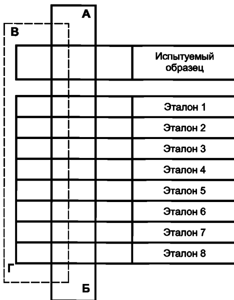
Рисунок 2 — Схема расположения испытываемого образца, синих эталонов и покрытий по методу 3
