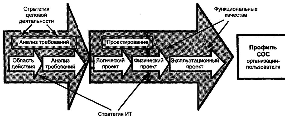
Рисунок 12 — Общая модель разработки профиля СОС организации-пользователя
