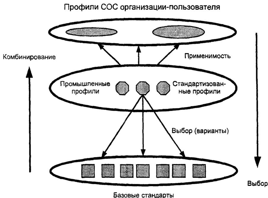
Рисунок 4 — Взаимосвязь между стандартами и различными типами профилей
