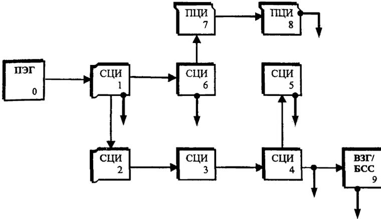
Рисунок А.2 - Граф прохождения основного синхросигнала
