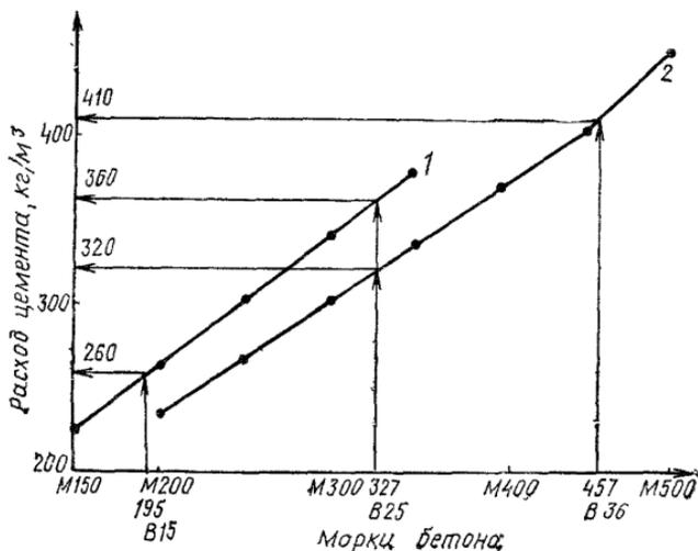
График зависимости расхода цемента марки 400 (1) и марки 500 (2) от марки бетона
