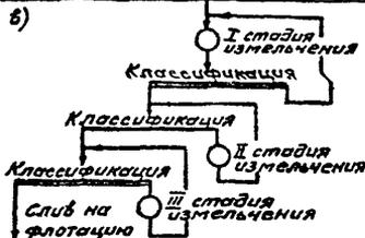
Схему „в“ надлежит применять при измельчении весьма тонковкрапленных руд, не склонных к переизмельчению.
