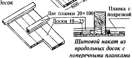
Щитовой накат из продольных досок с поперечными планками
