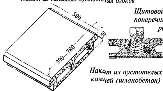
Накат из гипсовых пустотелых блоков
