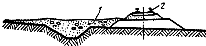
Рис. П.8.47. Завалы пути селевыми отложениями: 1 — селевые отложения; 2 — путь
