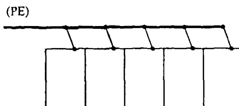
Рисунок 6 - Последовательно-параллельная схема заземления корпусов стоек аппаратуры ВОЛП
