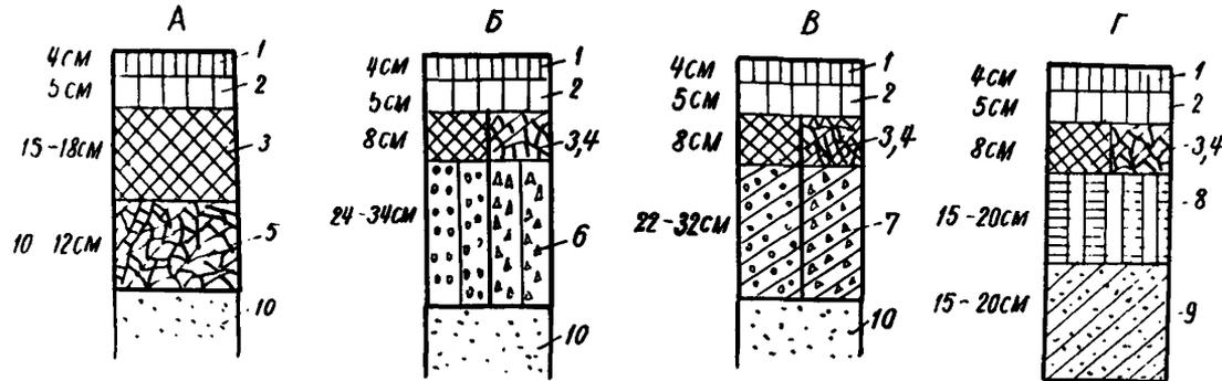
Рис.1. Типы конструкций дорожных одежд с асфальтобетонным покрытием для дорог с тяжелым движением:
