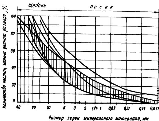
Рис.2. Графики гранулометрических составов битумо-минеральных, шлакоминеральных, зольно-минеральных и цементо-минеральных смесей
