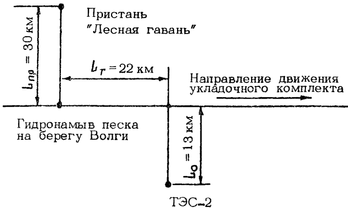
Схема расположения предприятий-поставщиков песка, золошлака и ПГС относительно трассы строящейся автомобильной дороги
