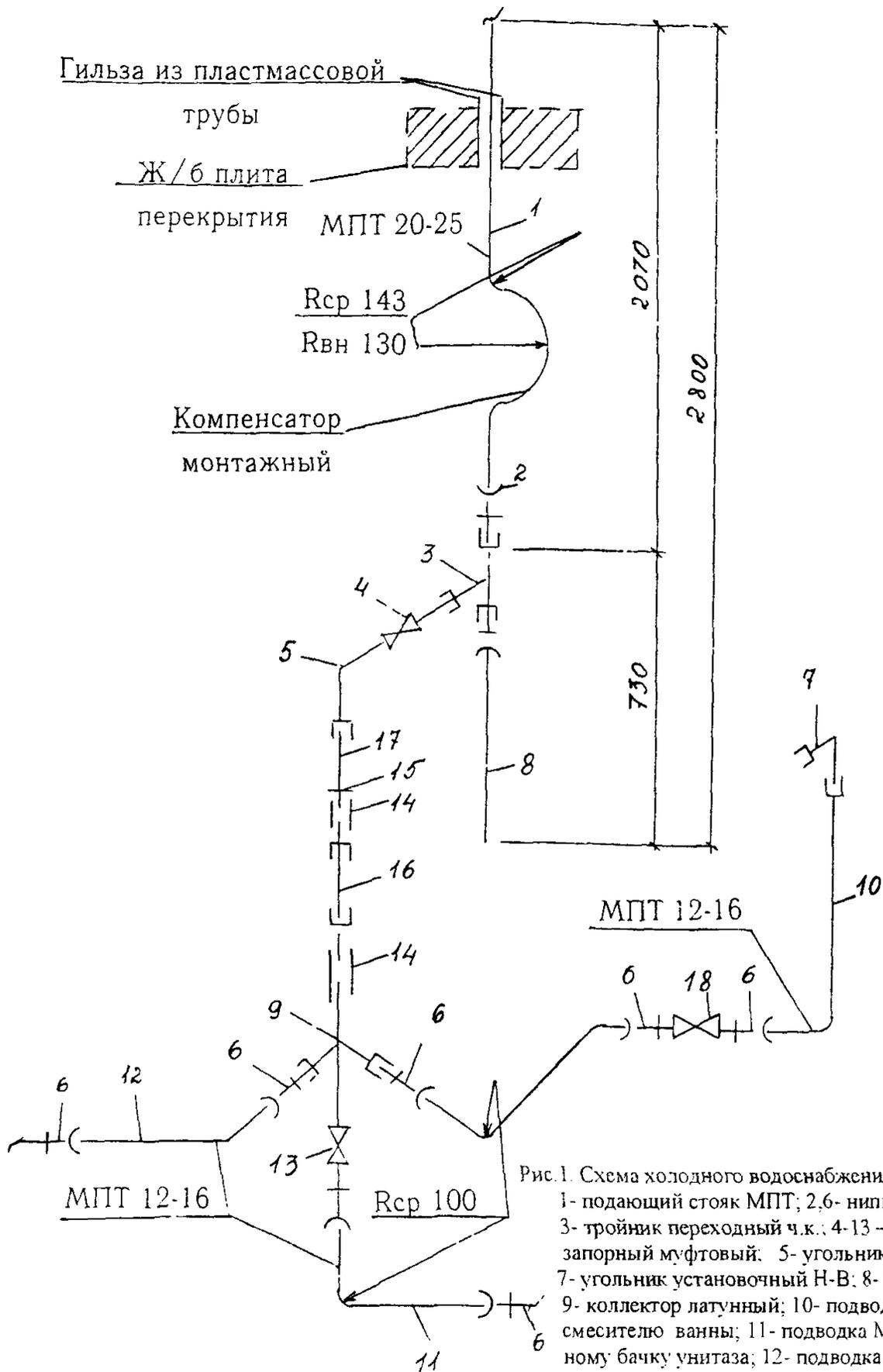
Рис. 1. Схема холодного водоснабжения из МПТ:
