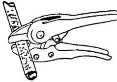
Рис. 3. Специальные ножницы для отрезания металлополимерных труб.
