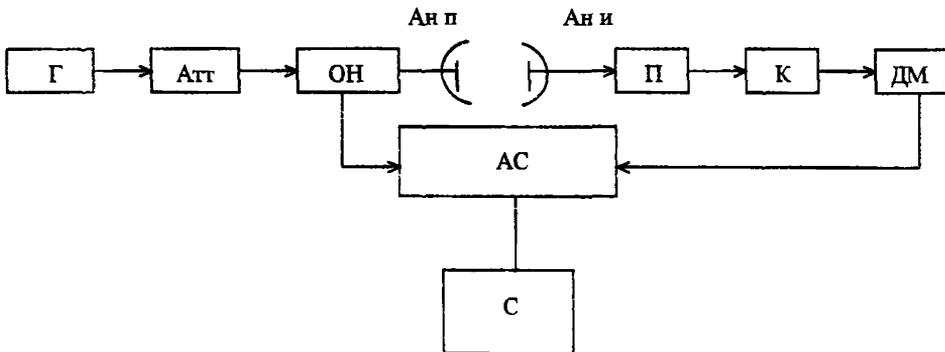
Рисунок 4 - Схема для измерений уровня боковых лепестков антенны
