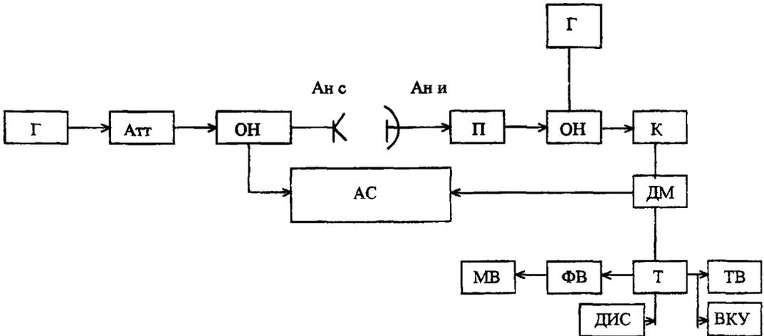
Рисунок 8 - Схема для измерений порогового отношения сигнал/шум
