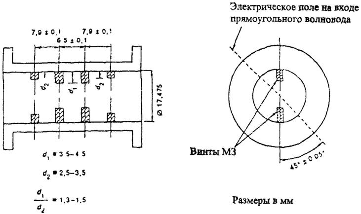
Рисунок А 4 - Основные размеры круглого поляризатора
