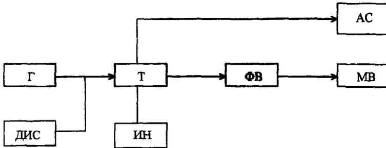
Рисунок 7 - Схема для измерений ширины полосы пропускания
