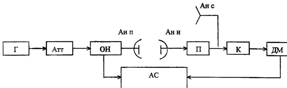
Рисунок 3 - Схема для измерения усиления антенны
