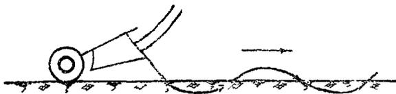
Рис 4 Схема зарезания грунта «клевками»
