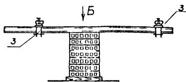
Кантовка панели из горизонтального в вертикальное положение
