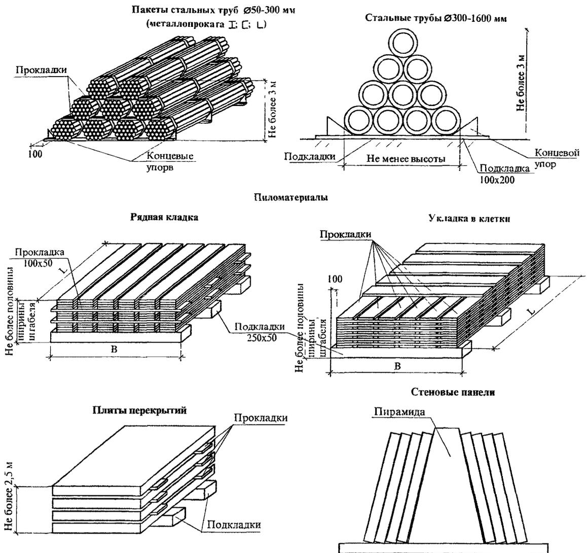
Рисунок 7 – Примеры складирования материалов, изделий и конструкций
