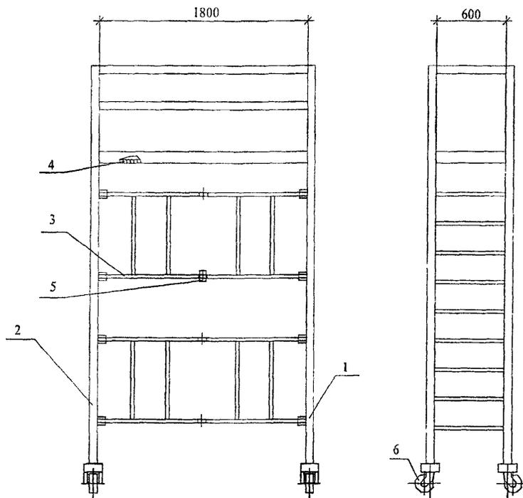
1, 2 – лестницы; 3 – ферма; 4 – настил; 5 – фиксатор; 6 – поворотные колеса
