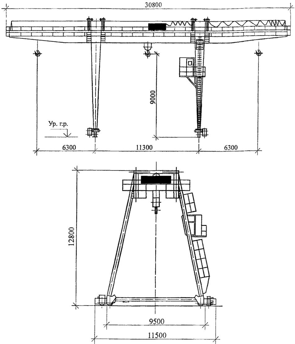
Рисунок 1 – Общий вид козлового крана КК 20-11,3-9
