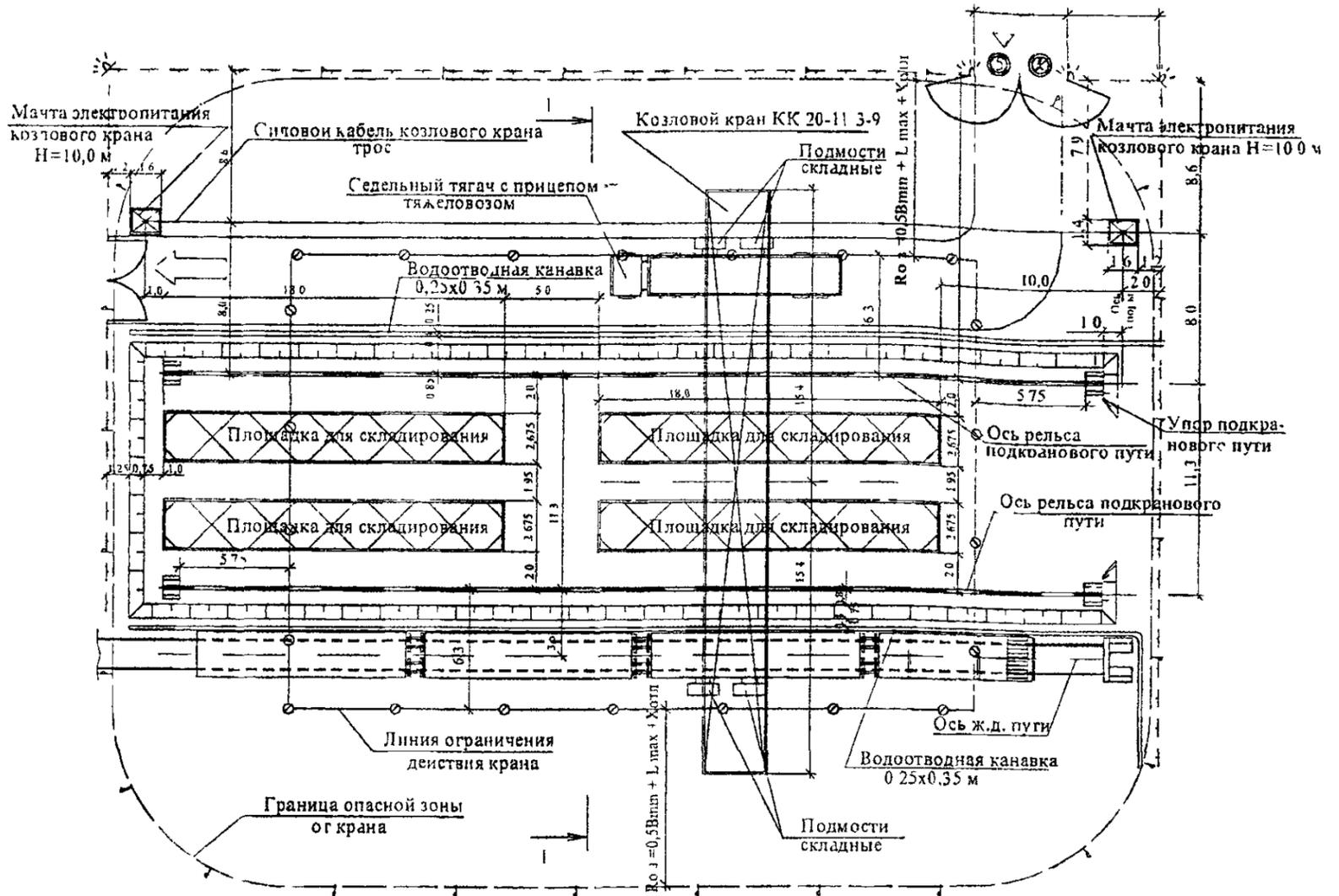
Рисунок 3 – Схема организации погрузочно-разгрузочных работ и складирования грузов
