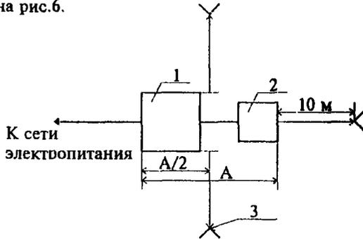
1 - испытуемое оборудование; 2 - выносное электрооборудование; 3 - положение антенны при измерениях; А - размер испытуемого оборудования с выносным оборудованием.
