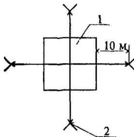
1 - испытуемое оборудование; 2 - положение антенны при испытаниях.
