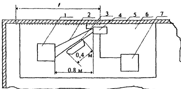
1 - испытуемое оборудование; 2 - провод заземления; 3 - соединительный шнур (кабель); 4 - эквивалент сети; 5 - стена экранированного помещения; 6 - стол; 7 - измеритель радиопомех;  $l$  - необходимый размер металлического листа при измерении вне экранированного помещения.
