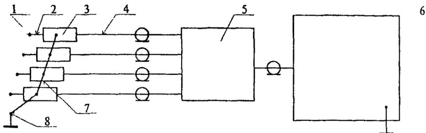
1 - зажимы на вводном распределительном устройстве (ВРУ); 2 - шины, подключающие пробники напряжения к зажимам ВРУ; 3 - пробники напряжения; 4 - соединительные коаксиальные кабели; 5 - переключатель фаз; 6 - измеритель радиопомех; 7 - шина, подключающая пробники напряжения к зажиму заземления; 8 - зажим заземления
