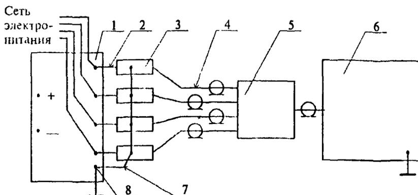
1 - испытуемое оборудование; 2 - шины, соединяющие пробник напряжения с зажимами устройства, 3 - пробники напряжения; 4 - соединительные коаксиальные кабели; 5 - переключатель фаз; 6 - измеритель радиопомех; 7 - шина, подключающая пробники напряжения к зажиму заземления, 8 - зажим заземления
