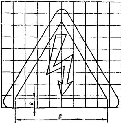
Рис. 5. Разметка изображения (ГОСТ 12.4.026-76):  $z=450$  мм;
