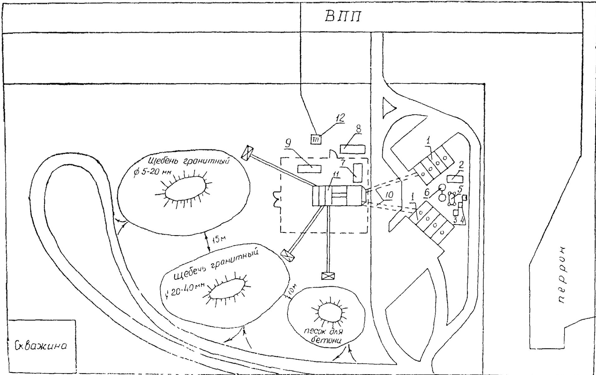
Рис. 1. План размещения смесительной установки «Рекс»:
