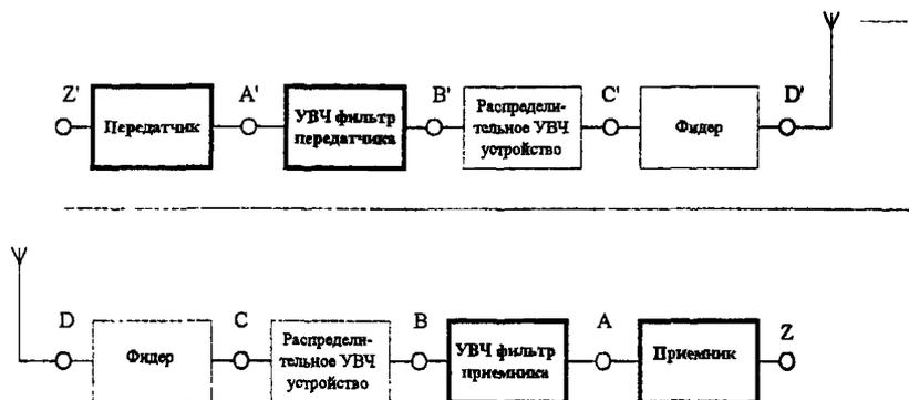
Рисунок 5.2 - Структурная схема радиоборудования APД FH-CDMA 1-3 ГГц
