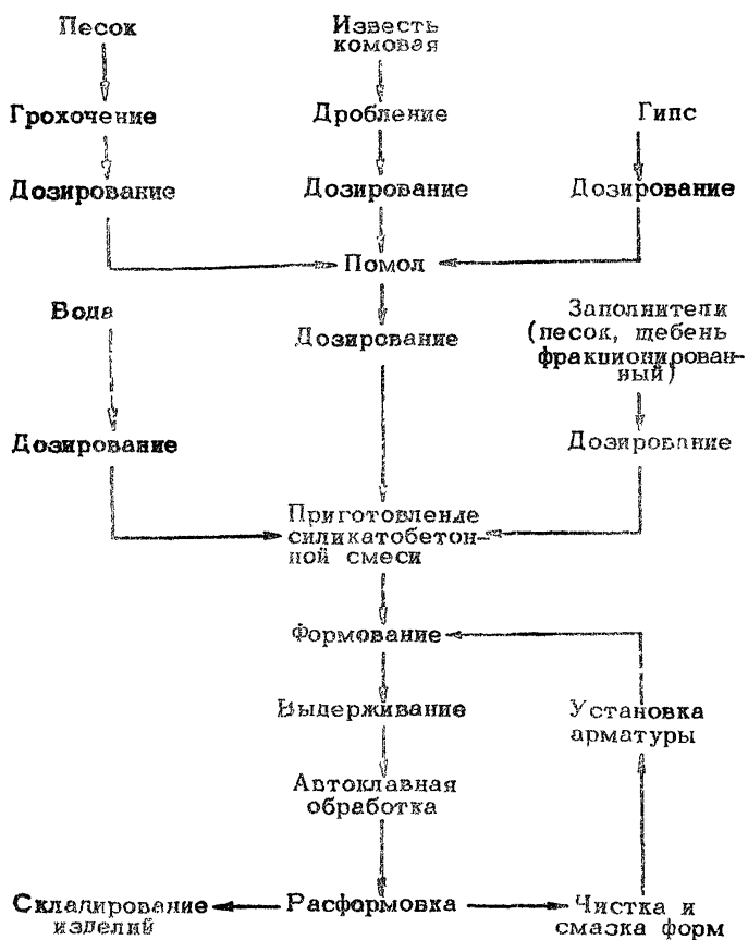
Рис.1. Технологическая схема производства дорожных изделий кипельным способом
