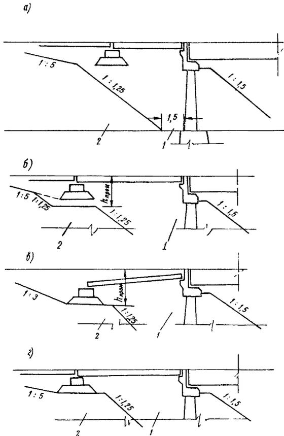
Рис.2. Схема общей компоновки узла сопряжения моста с насыпью:
