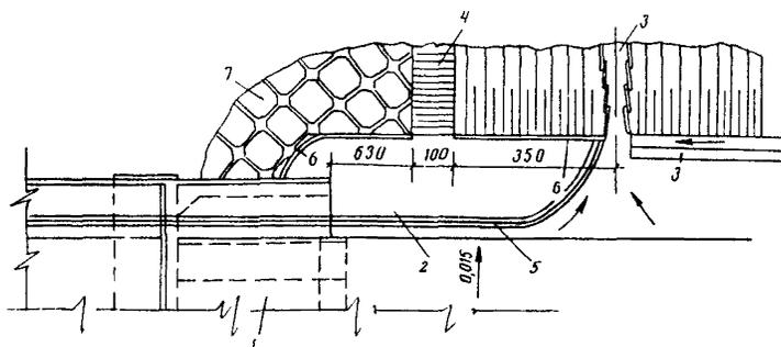
Рис.4. Пример устройства водоотвода в узле сопряжения (план):
