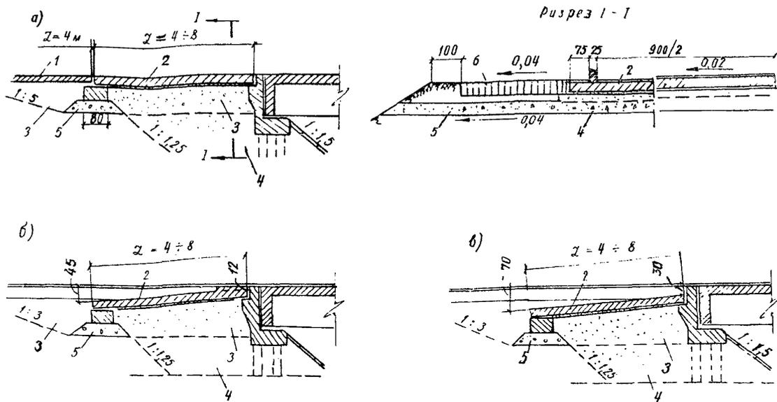
Рис.1. Конструкции сопряжения моста с насыпью для цементобетонных покрытий (а) и для асфальтобетонных - полузаглубленные плиты (б), заглубленные (в):
