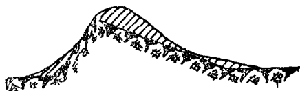
Р и с. 32. Отложения снега у узких, невысоких гряд с обращенным к ветру крутым склоном
