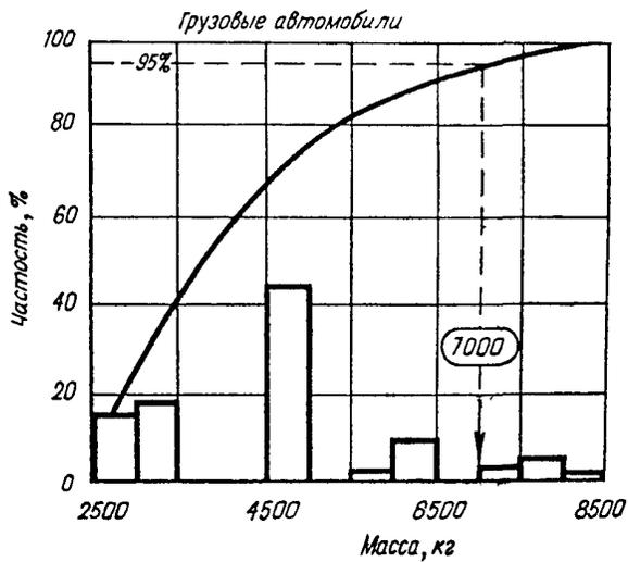
Рис.19. Распределение по массе транспортных средств, участвовавших в наездах на препятствия и съездах с дороги с опрокидыванием
