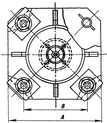
Рис. 9. Конструкция скользящего соединения:
