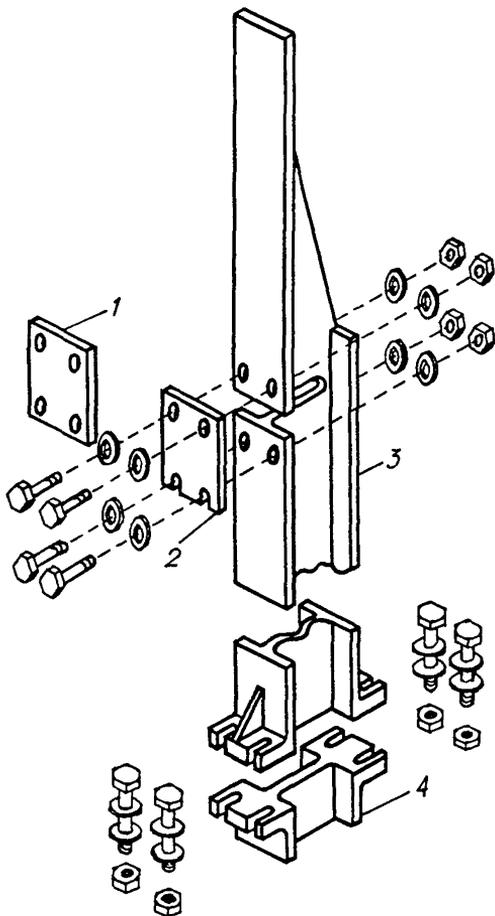
Рис. 8. Детали конструкции опор разрушающихся знаков:
