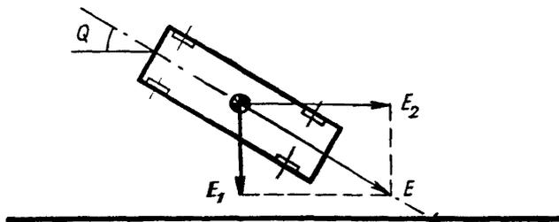
Рис. 21. Определение угла наезда на препятствие и поперечной составляющей энергии движущегося автомобиля
