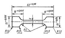
перечном направлении производят по п. 10 настоящего стандарта на 10 образцах в форме лопаток (изображенных на чертеже).
