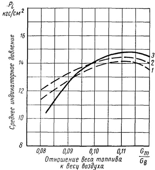
1 — эталонное топливо стандартной сетки; 2 — эталонное топливо стандартной сетки, снятое в день испытания; 3 — испытуемое топливо
