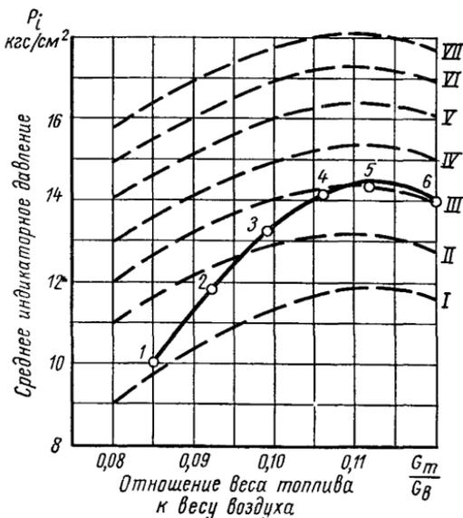
I — технический эталонный изооктан (ТЭИ); II — ТЭИ + 0,19 мл/кг тетраэтилсвинца (ТЭС); III — ТЭИ + 0,48 мл/кг ТЭС; IV — ТЭИ + 0,76 мл/кг ТЭС; V — ТЭИ + 1,15 мл/кг ТЭС; VI — ТЭИ + 1,53 мл/кг ТЭС; VII — ТЭИ + 2,30 мл/кг ТЭС.
