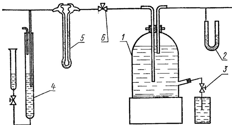
Рис. 4. Установка для калибровки реометров
