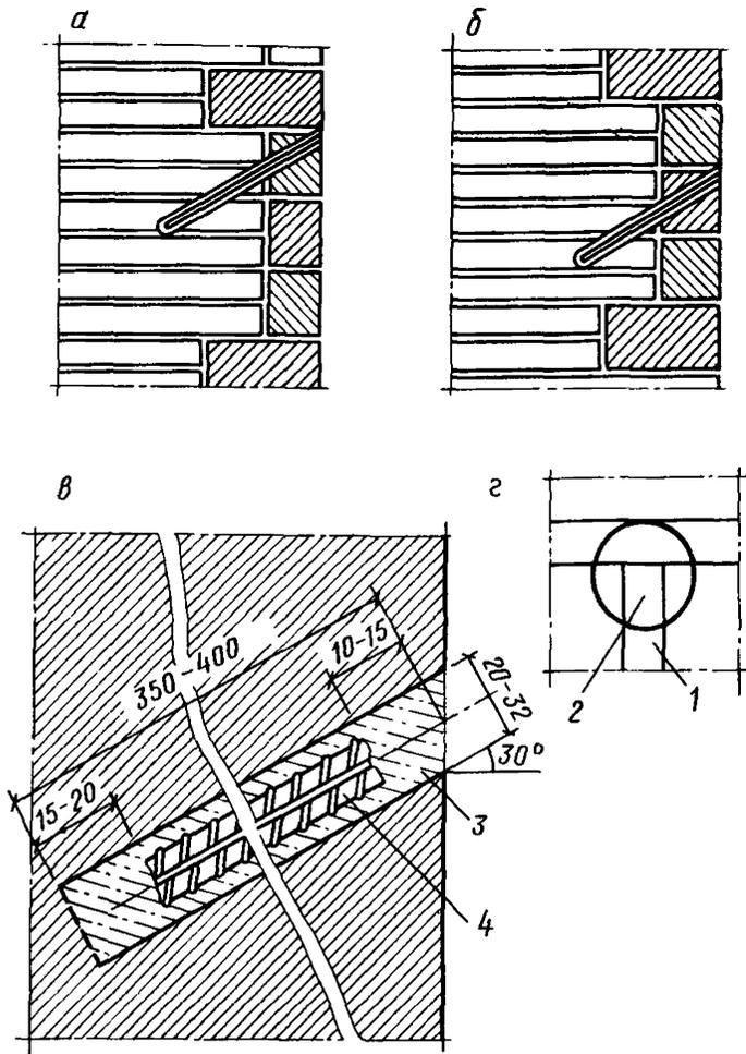
**Рис. 16. Заделка стержней в кладку для крепления облицовки**
