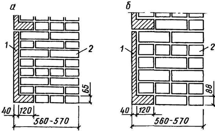
**Рис. 11. Облицовка стен зданий Г-образными закладными бетонными плитами**
