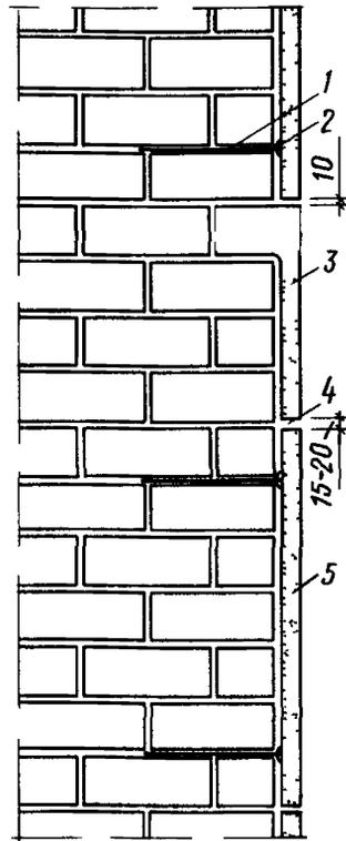
**Рис. 12. Кладка из кирпича или камней с облицовкой фасадными бетонными плитами**
