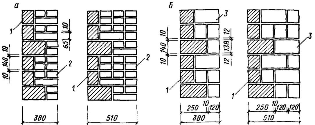
**Рис. 2.** Облицовка лицевыми керамическими или силикатными камнями стен
