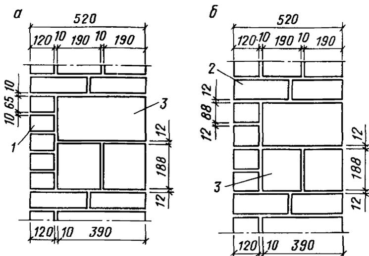
**Рис. 4.** Облицовка лицевым кирпичом стен из бетонных камней
