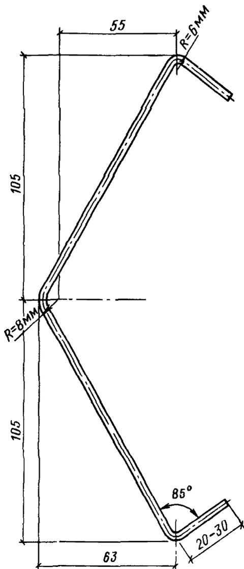
**Рис. 13. Пружинная закрепа**
