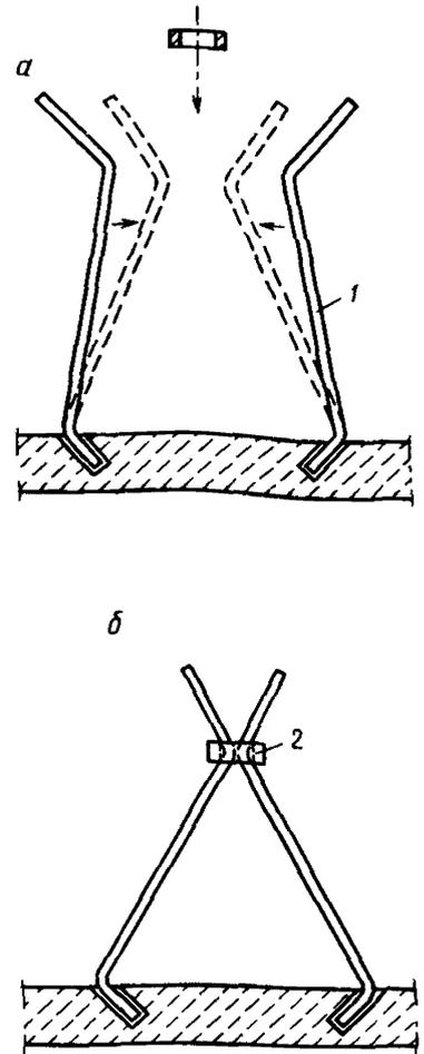
**Рис. 14. Установка разъемной закрепы**
