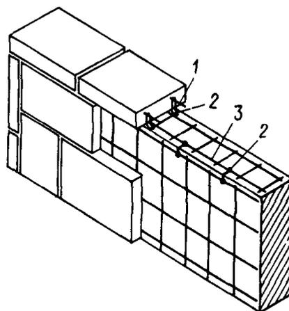
**Рис. 9.** Крепление плит природного камня в оконном проеме под перемычкой
