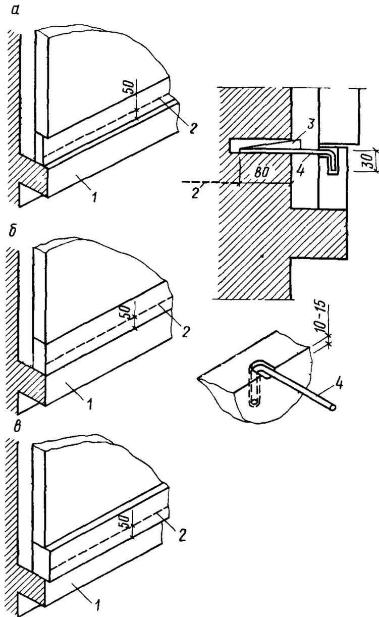
**Рис. 7. Облицовка цоколя здания плитами**
